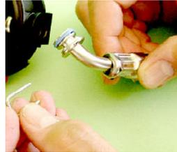
**Bild 26 Demontage Mitteldruckleitung**
