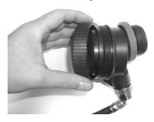
**3.1.5** Die Membraneinheit aus dem Lungenautomaten-Gehäuse ziehen.
