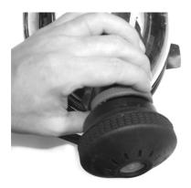
**3.1.2** Den Mitteldruckschlauch vom Pressluftatmer lösen.
