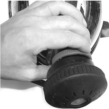
**3.1.2** Den Mitteldruckschlauch vom Pressluftatmer lösen.
