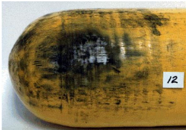
Abb. 6 Hitze- und Feuerschäden
