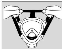
Stropesystemet føres over hovedet og trækkes bagud, indtil frontstroppen sidder glat. Masken trækkes helt på plads.
