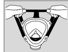
Bänderung über den Kopf führen und nach hinten streifen, bis das Stirnband glatt liegt. Vollmaske zurechtrücken.
