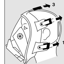
**Sızdırmazlık kontrolü:** Maske bağlantısı sızdırmayacak şekilde tutulmalı ve vakum oluşuncaya kadar nefes alınmalıdır. Vakum sabit kalmalıdır, aksi halde badajlar tekrar sıkılmalıdır. Sızdırmazlık kontrolü iki kez tekrarlanmalıdır. **Gerektiğinde sadece sızdırmayan tam maske kullanılmalıdır!**
