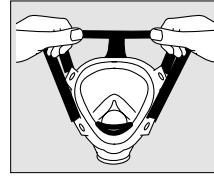
**Colocación de la mascarilla integral:** Las personas con barba y patillas en la zona de hermetizado no deben emplear estas mascarillas integrales, ya que se pueden producir fugas. Las patillas de gafas en la zona de hermetizado también producen fugas. Se deberán emplear gafas de mascarilla. Abrir la cinta de transporte. Introducir la barbilla en el apoyo correspondiente.
