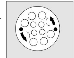
**Konuşma diyaframının veya O-Ring'in değiştirilmesi:** Vida dişli halka, R 26 817 pim anahtarı ile yerinden sökülp çıkarılmalıdır. Anahtar çevrilmeli ve dikkatle koruyucu izgaranın deliklerine sokulmalıdır; diyafram folyosunun zedelemesmesine dikkat edilmelidir. Konuşma diyaframı çevrelerip gevşetip, dışarı çıkarılmalıdır. O-Ring, conta kaldırıcı R 21 519 ile bağlantı parçasından dışarı çıkarılmalıdır. Konuşma diyaframı ve O-Ring kontrol edilmeli ve gerekirse değiştirilmelidir.
