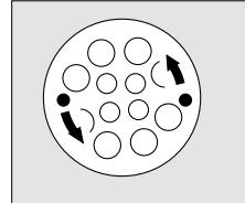
**Utskifting av utåndingsventilskive:** Se "Visuell kontroll av utåndingsventil". Sett på beskyttelseskappen som må raste inn.
