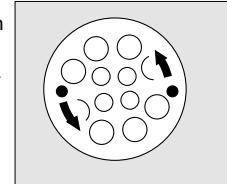
**Substituir a arruela da válvula de expiração:** Vide "Controlo visual da válvula de expiração". Colocar a capa de protecção, esta tem que engatar-se.
