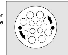
**Remplacement de la membrane phonique ou du joint torique:** Dévisser l'anneau fileté avec la clé à ergots R 26 817. Retourner la clé et l'insérer précautionneusement dans les trous de la grille de protection en veillant à ne pas endommager la membrane. En tournant, désolidariser la membrane phonique et la retirer. Retirer le joint torique du raccord avec l'extracteur R 21 519. Contrôler la membrane phonique et le joint torique et les remplacer si nécessaire.
