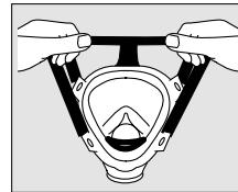
Passer le jeu de brides sur la tête et tirer en arrière jusqu'à ce que la bride frontale repose à plat. Ajuster le masque complet.
