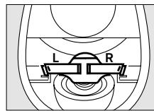
Ventilschijfje en zetel moeten schoon en onbeschadigd zijn, anders reinigen of vervangen. Ventilschijfje met water bevochtigen en inzetten. Het ventilschijfje moet door haar eigen gewicht in de geleider glijden.
