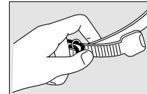
**Tam maskenin çıkarılması:** İşaret parmağı ense bandajlarının uçlarının arkasına sokulmalı, baş parmakları ile sıkıştırma tokaları öne doğru bastırılmalı ve aynı zamanda tam maske yüzden uzaklaştırılarak kafanın üzerinden çekilipli çıkarılmalıdır.
