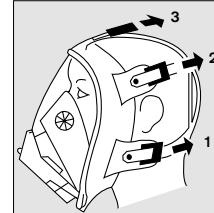
**Comprobación de la hermeticidad:** Taponar el conector de la mascarilla e inspirar hasta crear un ligero vacío. Mantener la respiración brevemente. El vacío no se deberá perder, de lo contrario se deberán tensar las cintas. Repetir dos veces la prueba de hermeticidad. ¡La mascarilla sólo se deberá emplear si no presenta fugas!
