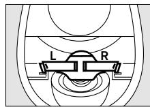
Humecter d'eau le disque de valve et l'insérer. Le disque de valve doit glisser dans le guide par son propre poids. Insérer le pont à ressort de telle manière que les deux tiges s'emboîtent latéralement. Il est marqué de "L" (= "links") à gauche et de "R" (= "rechts") à droite et est coudé.
