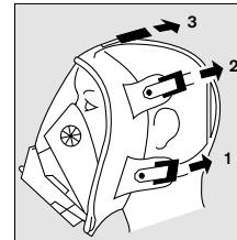
**Contrôle de l'étanchéité:** obturer le raccord du masque et inspirer jusqu'à créer une dépression. Retenir brièvement la respiration. La dépression doit se maintenir; sinon, resserrer les brides. Répéter deux fois le contrôle d'étanchéité. **L'intervention ne doit avoir lieu qu'avec un masque étanche!**
