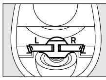
Διαφορετικά καθαρίστε ή αλλάξτε τα. Βρέξτε τον δίσκο της βαλβίδας με νερό και τοποθετήστε τον. Ο δίσκος της βαλβίδας πρέπει να γλιστρήσει μέσα στον οδηγό χωρίς καθόλου πίεση. Τοποθετήστε το στήριγμα του ελατηρίου με τέτοιο τρόπο, ώστε και το σκέλος να εφαρμόσουν και στις δύο πλευρές. Το ελατήριο φέρει τα διακριτικά "L" (αριστερά) και "R" (δεξιά) και τοποθετείται υπό κλίση.
