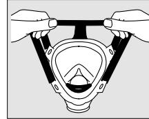
Bänderung über den Kopf führen und nach hinten streifen, bis das Stirnband glatt anliegt. Vollmaske zurechtrücken.
