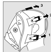
**Op lekkage controleren:** Gelaatstukaansluiting afsluiten en inademen totdat er onderdruk ontstaat. Even de adem inhouden. De onderdruk moet gehandhaafd blijven, anders de banden natrekken. Lektest twee keer herhalen. **Gebruik het masker niet als de lekkage niet verholpen kan worden!**
