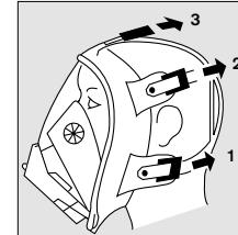
**Controlar a estanqueidade:** Vedar a conexão da máscara, e aspirar até que se produza uma depressão. Reiterar a aspiração durante pouco tempo. A depressão tem que ficar mantida, senão, reapertar as fitas. Repetir duas vezes o controlo da estanqueidade. **Só iniciar o emprego com a máscara integral sem fuga!**
