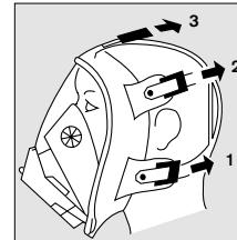
**Tæthedskontrol:** Masketilslutningen holdes tæt og der indåndes, indtil der opstår et vakuum. Hold vejret et øjeblik. Vakuumet skal forblive uændret, ellers skal stropperne strammes. Tæthedskontrollen gentages to gange. **Helmasken må kun bruges, hvis den er helt tæt!**
