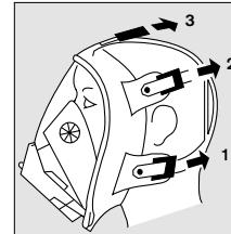
**Tettethetskontroll:** Hold maskekoplingen tett til og pust inn inntil det oppstår et undertrykk. Hold pusten et øyeblikk. Undertrykket skal holde seg, ellers etterstrammes båndene. Gjenta tettethetskontroll to ganger.
