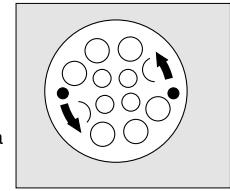
**Sustitución de la membrana de voz o de la junta tórica:** Desenroscar el anillo con una llave de espigón R 26 817. Girar la llave de espigón e insertarla cuidadosamente en los agujeros de la rejilla de protección sin dañar la lámina de la membrana. Girar la membrana de voz para soltarla y sacarla. Sacar la junta tórica del conector con ayuda del extractor de anillos junta R 21 519.
