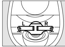
değiştirilmelidir. Ventil diskini su ile nemlendirip yerine takılmalıdır. Ventil diskı, kendi ağırlığı ile yuhanın içine kayıp oturmalıdır. Yay köprüsü öyle takılmalıdır ki, her iki kol da yan taraflara iyice otursun. Bir açı oluşturacak şekilde olan bu parça üzerinde, sol taraf için "L" ve sağ taraf için "R" harfi bulunmaktadır.
