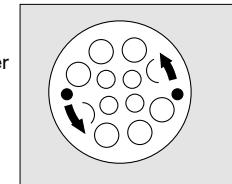
**Uitademventilschijf vervangen:** Zie "Uitademventiel visueel controleren". Beschermkap aanbrengen, moet inknakken.
