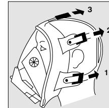
**Sprawdzić szczelność maski:** Zatkać przyłącze maski, wciągnąć powietrze tak, aby powstało podciśnienie. Na krótko zatrzymać powietrze w płucach. Podciśnienie musi się utrzymać; jeżeli tak nie jest, dociągnąć opaski. Kontrolę szczelności powtórzyć dwa razy.
