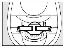
**Kontrola z zatkanim zaworem wydechowym:** Wymontować płytę zaworu wydechowego. Założyć zatyczkę zaworu A i zamocować z mostkiem sprężynowym. Wytworzyć podciśnienie 10 mbar. Jeżeli zmiana ciśnienia jest mniejsza niż 1 mbar, po upływie 1 minuty zdjąć zatyczkę zaworu A, założyć nową płytę zaworu i powtórzyć kontrolę; jeżeli tak nie jest:
