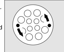
**Udskiftning af udåndingsventilskiven:** Se "Visuel kontrol af udåndingsventilen". Beskyttelseskappen sættes på og skal falde i hak.
