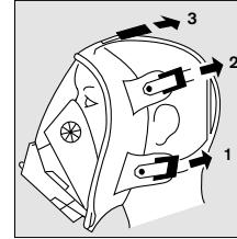
**Dichtheit prüfen:** Maskenschluss dichthalten und einatmen bis ein Unterdruck entsteht. Luft kurzzeitig anhalten. Der Unterdruck soll bestehen bleiben, sonst Bänder nachziehen. Dichtprüfung zweimal wiederholen. **Einsatz nur mit dichter Vollmaske antreten!**
