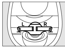
Eseguire il controllo a vista: il disco e la sede della valvola devono essere puliti e non danneggiati, in caso contrario occorre pulirli o sostituirli. Inumidire con acqua il disco della valvola e applicare la valvola. Inserire la molla e il ponte a molla in modo che entrambe le asticelle si incastriano lateralmente. Il ponte a molla è contrassegnato con "L" = sinistra e "R" = destra e deve essere ad angolo.
