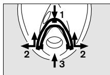
Vollmaske mit neuem Maskenanschluss bzw. neuem Maskenkörper zusammenbauen.
