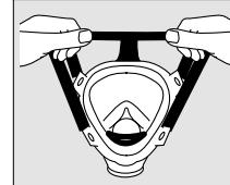
Bandajlar kafa üzerinden geçirilmeli ve alın bandı düzgün bir şekilde oturuncaya kadar arkaya doğru sıyrılmalıdır. Tam maske iyi oturacak şekilde yüzে yerleştirilmelidir.
