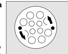
**Wymiana membrany fonicznej wzgl. pierścienia okrągłego:** Wykręcić pierścień gwintowany kluczem kolkowym R 26 817. Przekręcić klucz kolkowy i ostrożnie wpuścić w otwory kratki ochronnej. Nie uszkodzić folii membrany. Poluzować membranę foniczną przez jej przekreślenie i wyjąć. Wyjąć pierścień ochronny R 21 519 ściągaczem do uszczelki z przyłącza maski. Sprawdzić membranę foniczną i pierścień okrągły, w razie potrzeby wymienić te elementy.
