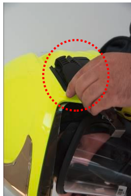
Vollmaske an das Gesicht pressen und Dicht- und Ausatemventilprüfung der Vollmaske durchführen
