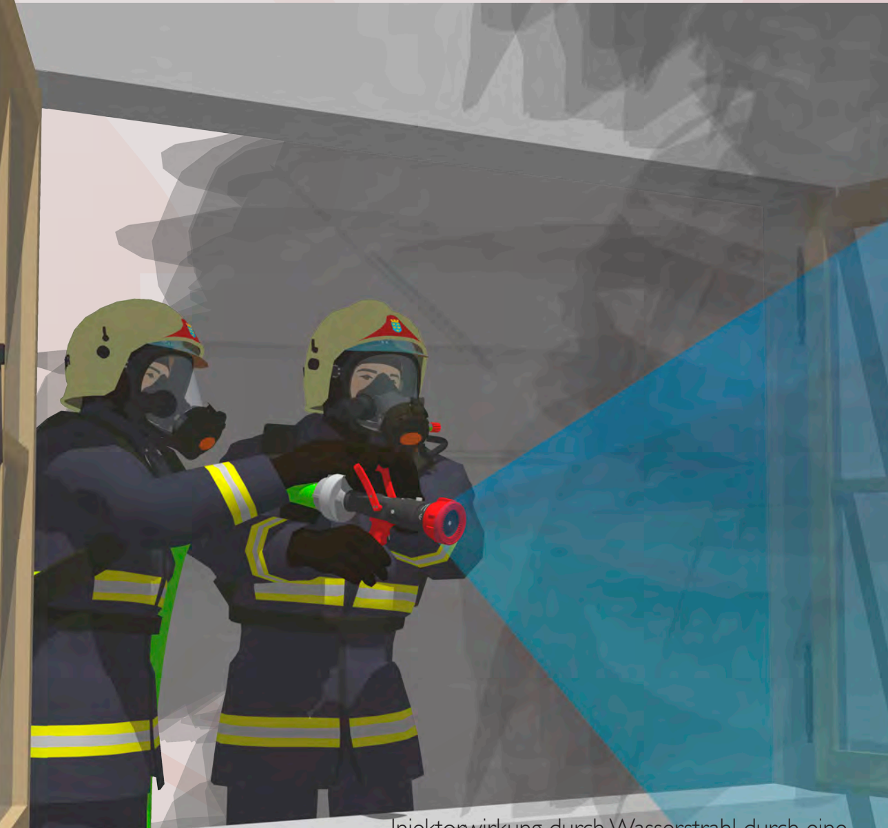
Injektorwirkung durch Wasserstrahl durch eine Öffnung, in diesem Beispiel ein Fenster
