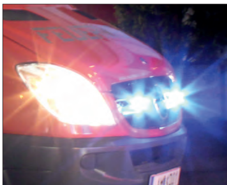
Im Kühlergrill integrierte superhelle LED-Blitzer
