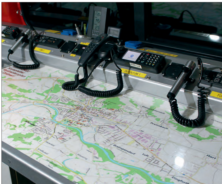
Tischplatte mit Plexiglasscheibe, unter der sich ein Stadtplan mit Hydrantenstandorten befindet
