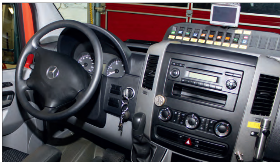
Sondersignalanlage, Navigationssystem und Außenlautsprecher sind vom Fahrerplatz aus leicht erreichbar
