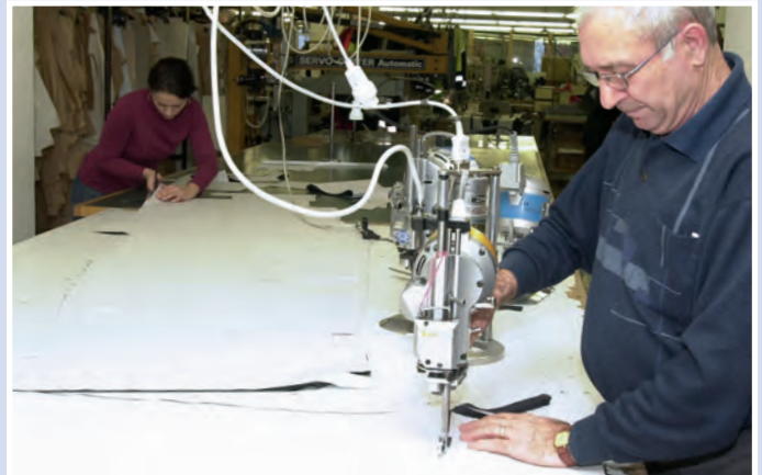
Zuschnitt. Nach dem Aufdruck des Schnittmusters werden die einzelnen Stoffteile ausgeschnitten.
