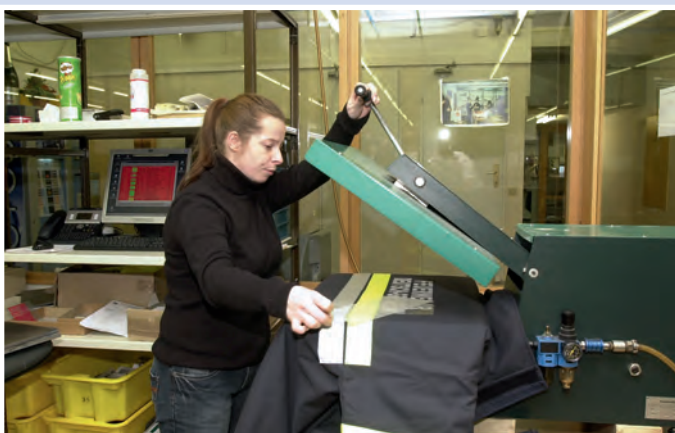
Aufdruck. Im letzten Arbeitsschritt erhält die Einsatzjacke ihre „Identität“, der Name der Feuerwehr wird aufgedruckt.
