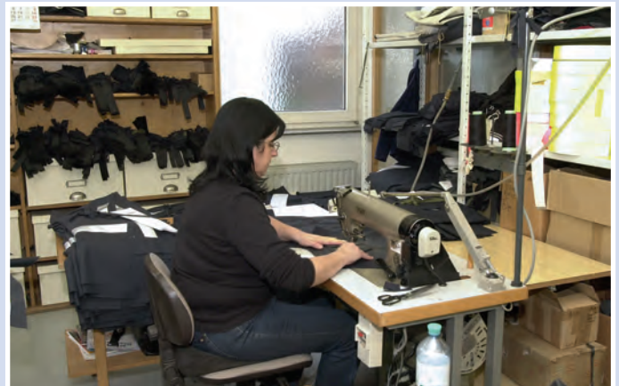
Montage. Taschen, Patten und Dienstgradschlaufen werden montiert.
