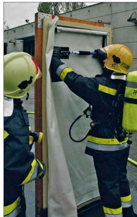
Zuletzt wir er mit einem Spannrahmen im Türstock fixiert
