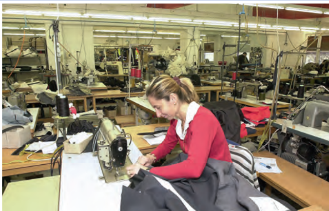
Vernähen. Von Hand werden Obermaterial, Nässesperre und Innenfutter vernäht. Unsere Schutzjacke ist jetzt schon halb fertig.
