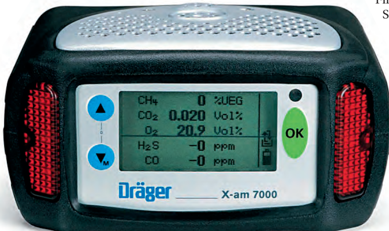
Dräger X-am 7000 für individuelle Messaufgaben
