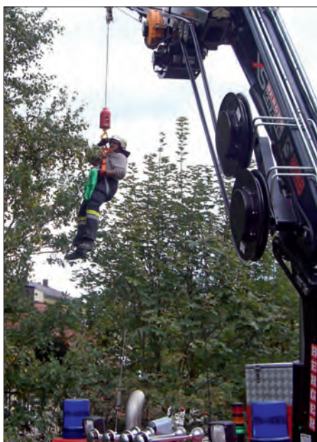
Kranseilwinde im Einsatz
