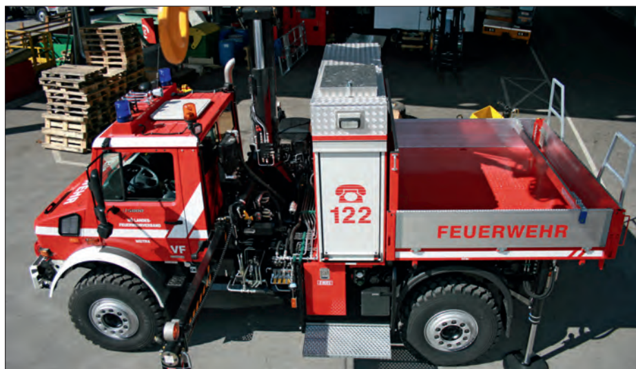
Aufbau hinter dem Ladekran: großzügige Beladeräume und Ladefläche
