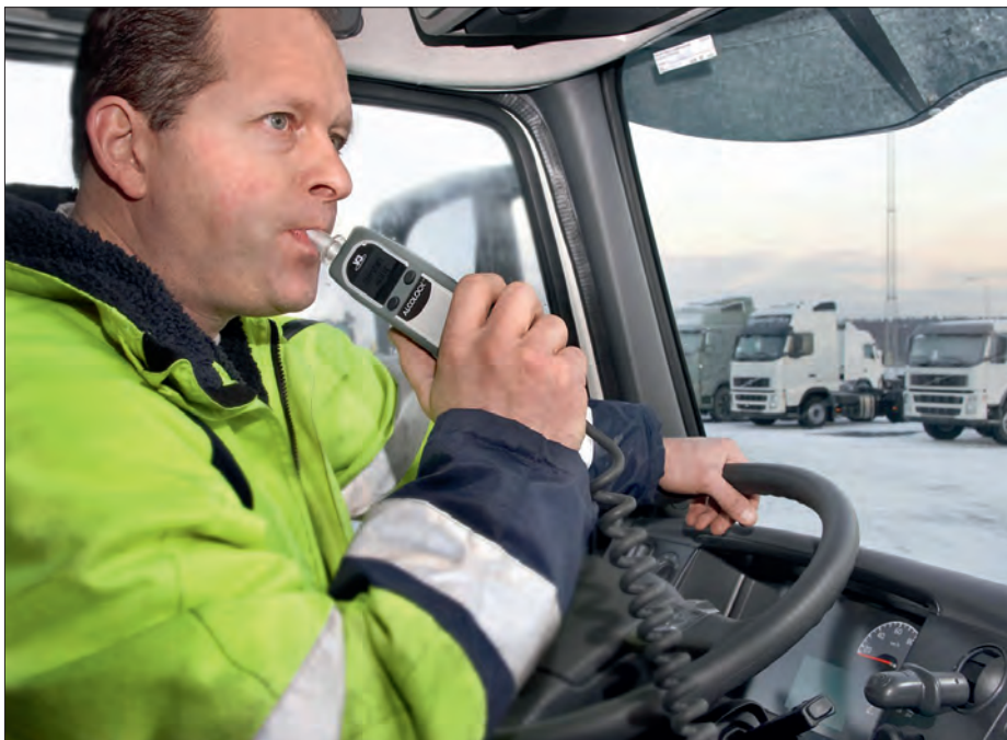
Volvo Trucks stattet seine Fahrzeuge bereits optional mit einer „atemalkoholgesteuerten Wegfahrsperr“ aus
