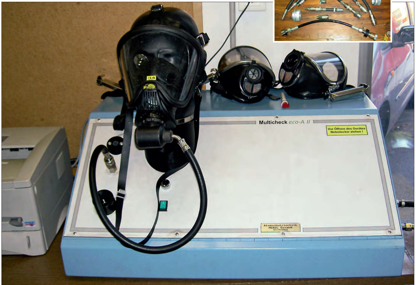
Das Prüfgerät, mit dessen Hilfe alle Pressluftatmer der niederösterreichischen Feuerwehren geprüft werden
