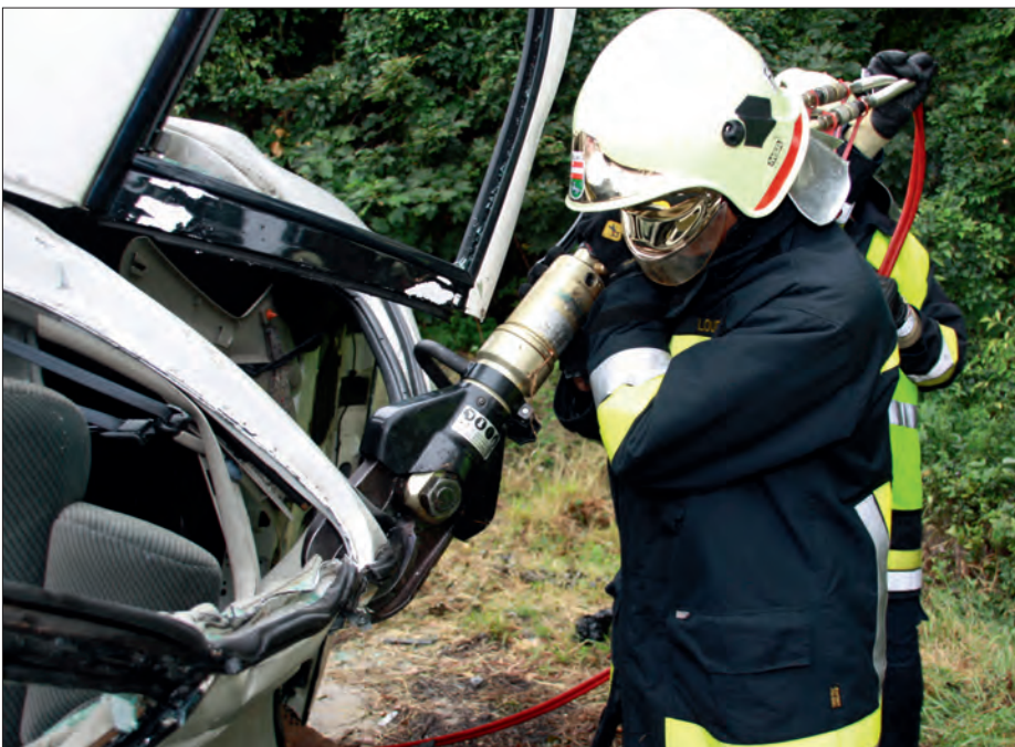
Besonderes Feingefühl ist beim Abnehmen des Fahrzeugdaches vonnöten
