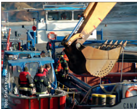
Vergeblicher Versuch mit dem Greifbagger eine 22 t Stahlblechrolle zu heben
