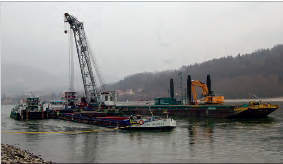
Schubschiff, Havarie, 80 t Schwimmkran, Leichter und Pontonbagger bilden eine eindrucksvolle Kulisse beim Entladen der schweren Fracht
