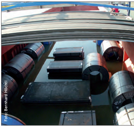
Der geflutete Frachtraum 1 mit einem Teil der rd. 800 t schweren Stahlladung
