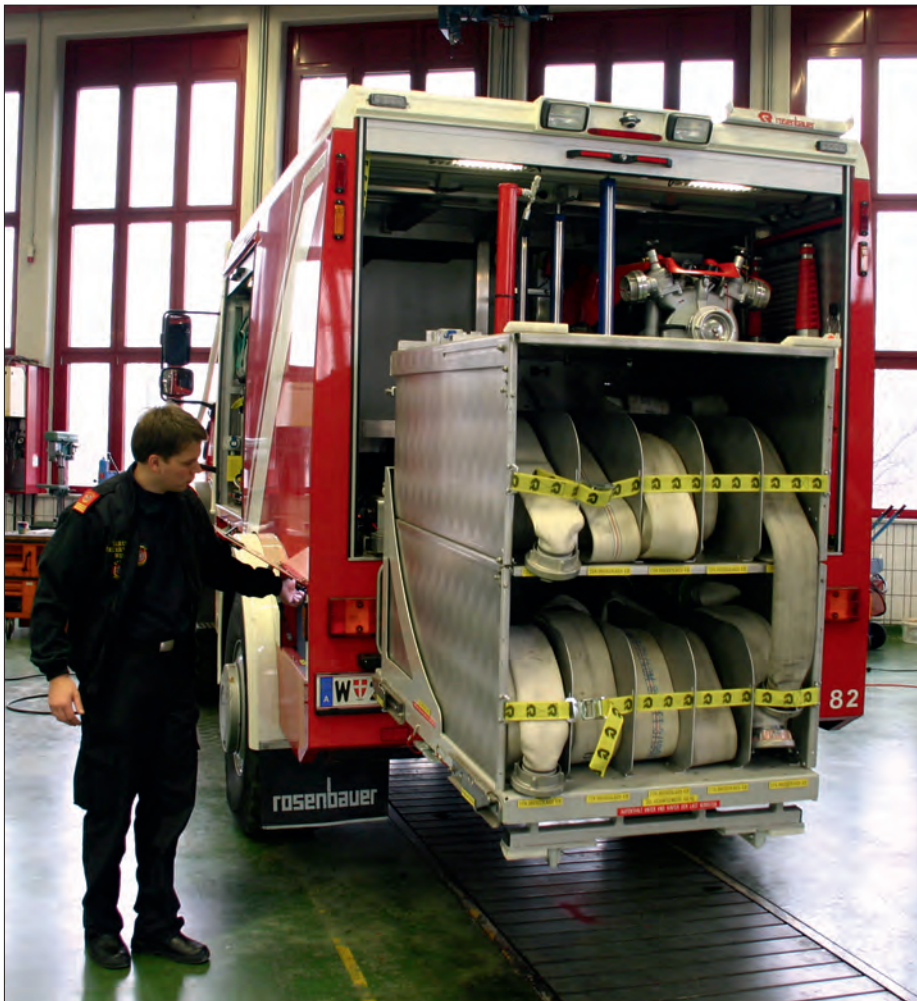
Im Heck befindet sich ein Saugstellenmodul mit einer Tragkraftspritze TS FOX inklusive Saugstellenausrüstung sowie ein Schlauchmodul mit etwa 400 m Schlauch
