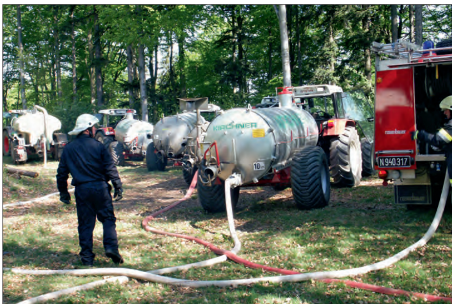
Vakuumfässer erwiesen sich für die Löschwasserförderung als sinnvoll
