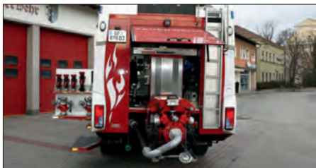
Ansaugen aus dem Tank mit abgesenkter Tragkraftspritze
