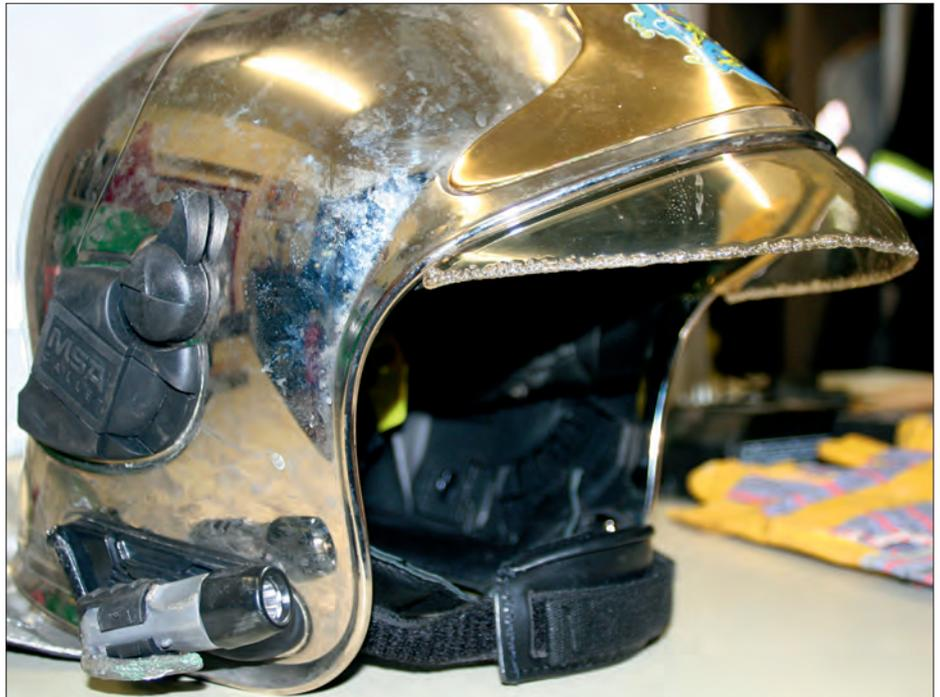
Verformung und Verfärbung eines Helmes durch extreme Temperaturen
