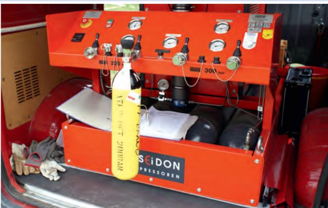
**Wiederbefüllen.** Mit dem Atemluftkompressorfahrzeug werden die Atemluftflaschen gleich wiederbefüllt. Hier benötigt man Fachpersonal.
