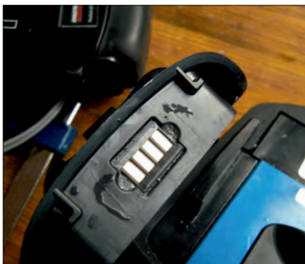
Feuchtigkeit auf Batteriekontakten ...
