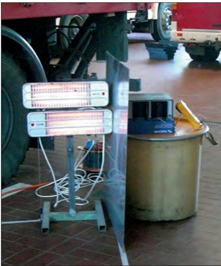
Verschiedene Wärmequellen mit konstanter Temperatur nebeneinander
