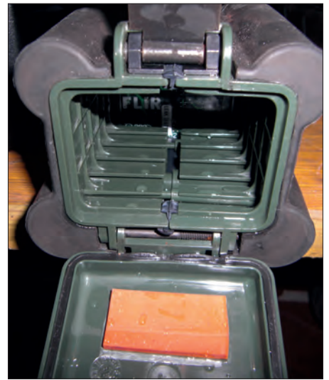
Undicht: Bei diesem Modell dringt Wasser ins Batteriefach ein
