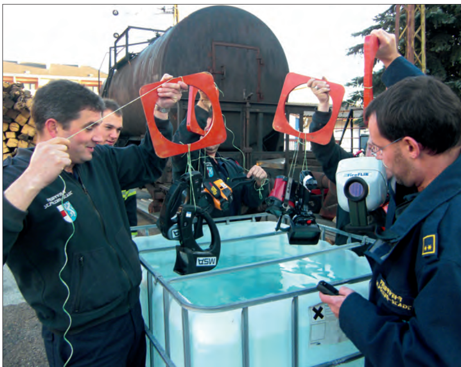
Dichtheitsprüfung bei 1 m Wassertiefe
