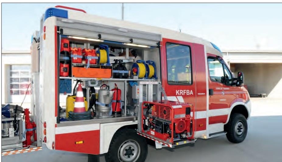
Einfache Entnahme durch absenkbar eingebauten Stromerzeuger
