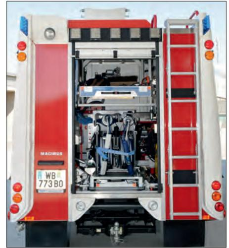
Hydraulisches Rettungsgerät im Heck
