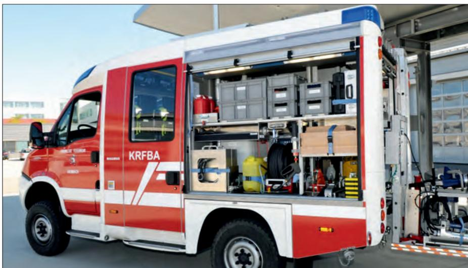
Die Löschanlage „HDL 250“ ist auf der Fahrerseite untergebracht
