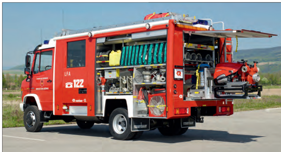
Absenkvorrichtung für die Tragkraftspritze im Heck des Fahrzeuges
