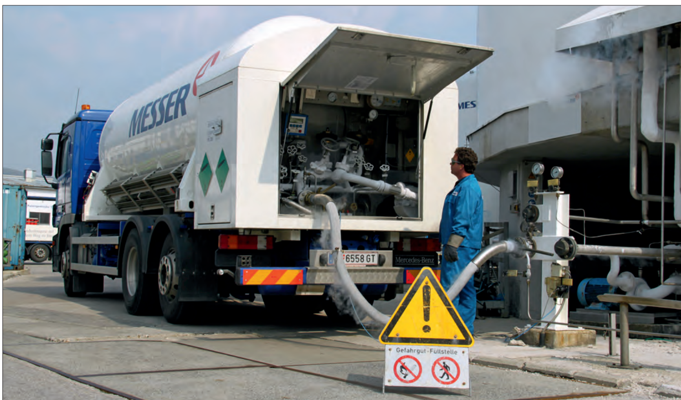
Betankung eines Flüssiggastransporters am Gelände der Messer Austria GmbH
