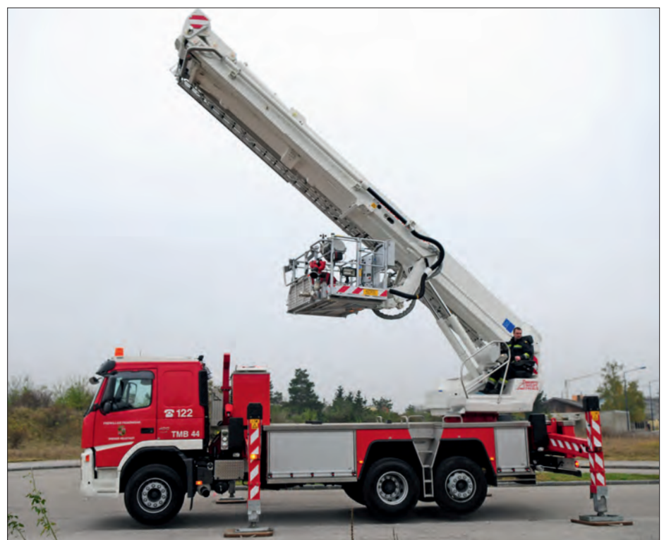
Wr. Neustadt: Volvo-Fahrgestell (FM400 6x2), 294 kW (400 PS) Leistung
