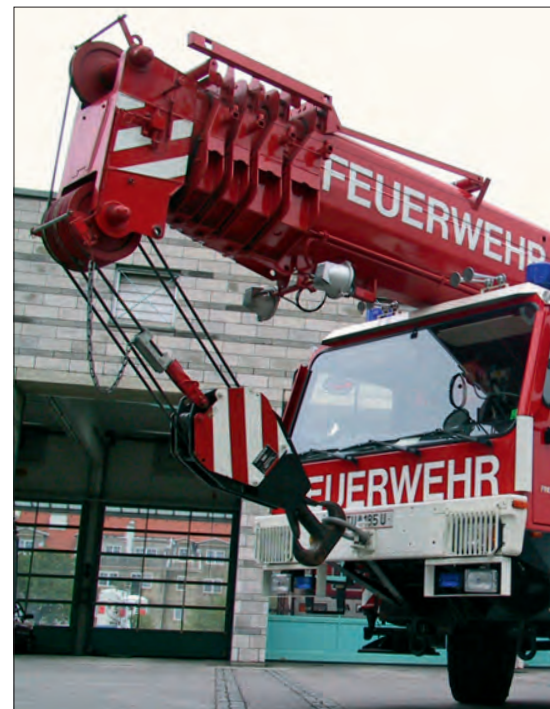
Kranfahrzeug Liebherr LTM 1070 / 1
