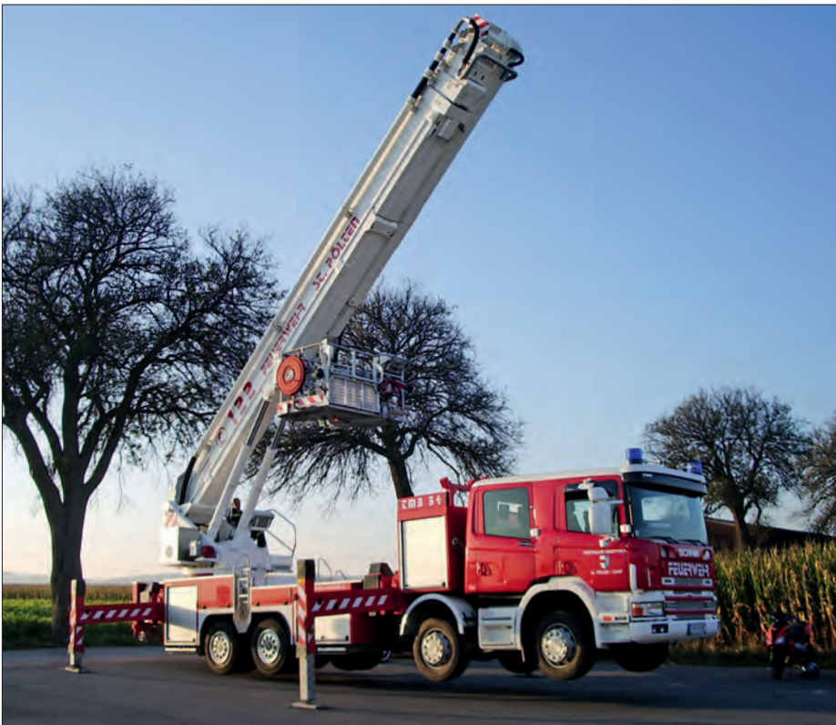
Doppelkabine: Teleskopmastbühne Bronto Skylift F 54 RLX in St. Pölten
