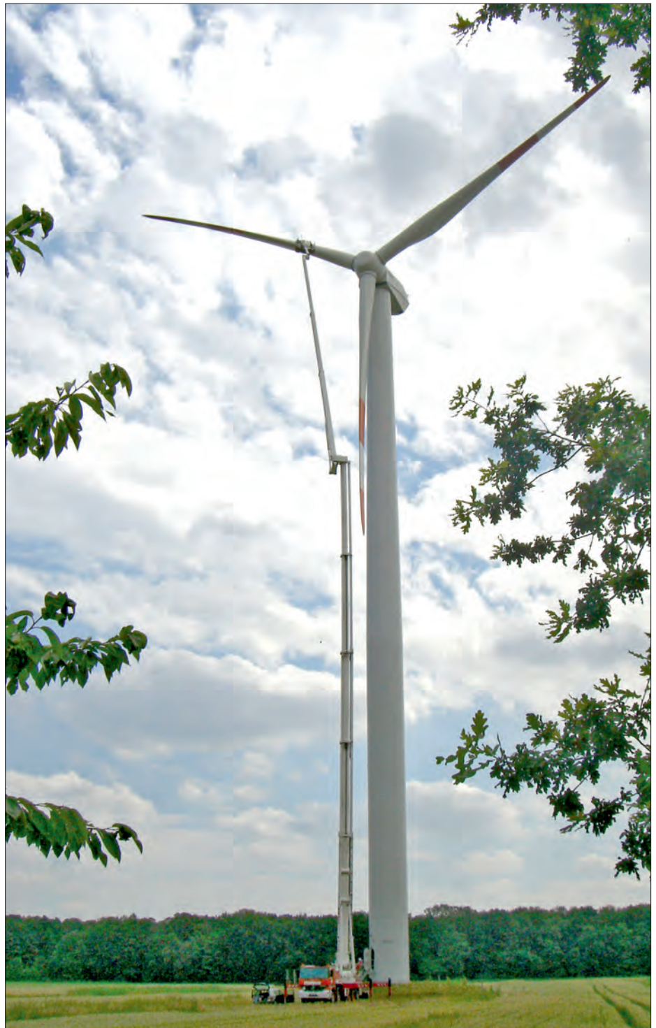
Spezialfahrzeuge von Bronto erreichen Arbeitshöhen von über 100 Meter ...
