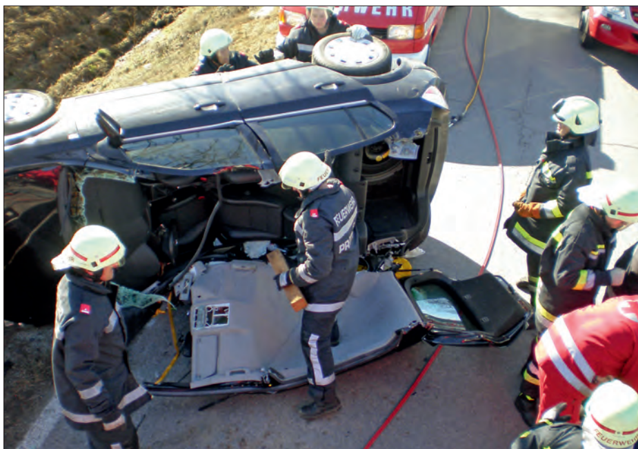
Das Dach musste zur Rettung der Person entfernt werden
