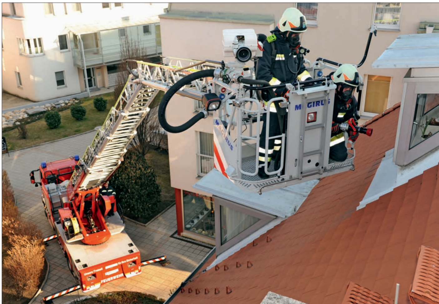
Der Rettungskorb verfügt u. a. über ein elektrisches Wendestrahrohr, eine Lüfterhalterung, Abseilbügel und Beleuchtungskörper
