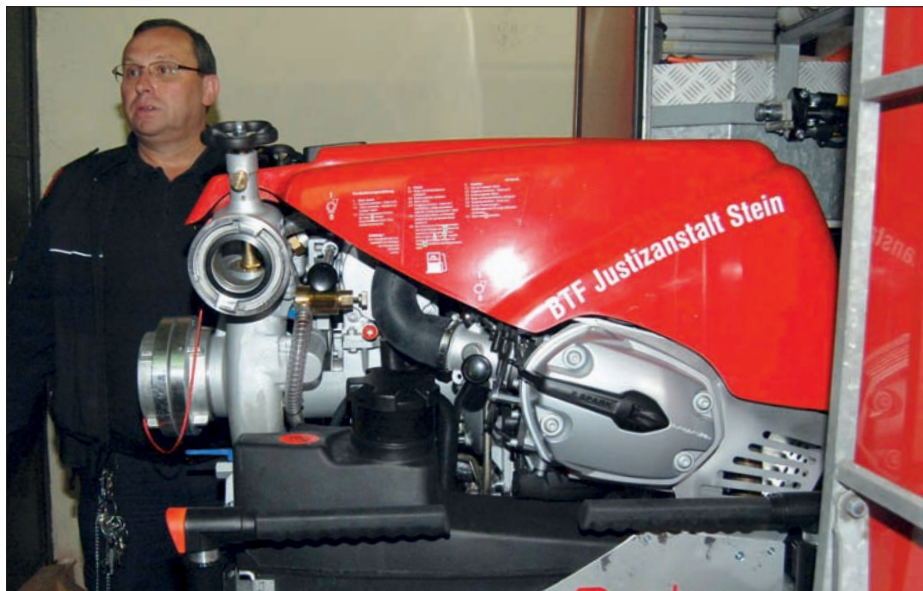
Die neueste Errungenschaft der BTF Stein: Tragkraftspritze FOX3
