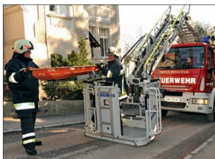
In engen Gassen von großem Vorteil: Der schwenk- und teleskopierbare Gelenkarm
