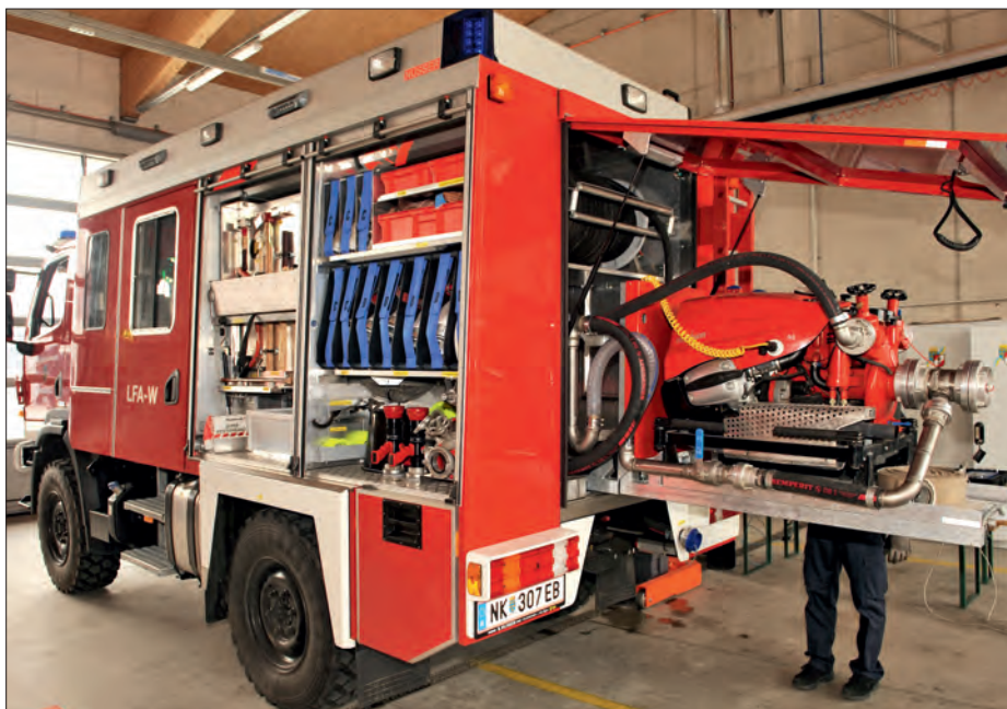
Die Tragkraftspritze kann pneumatisch abgesenkt werden. Dies erleichtert die Entnahme und spart wertvolle Sekunden im Einsatz.
