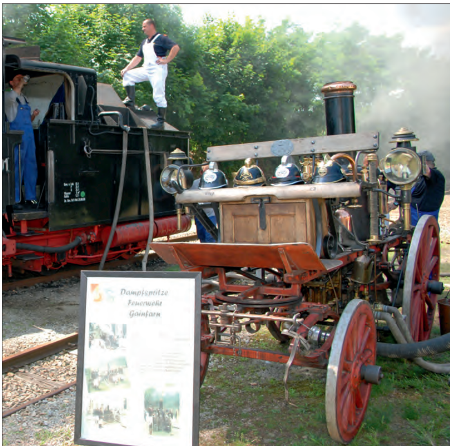
Die Gainfarner Dampfspritze in all ihrer Pracht. Das Knaust-Modell 1910 ist eine Zwei-Zylinder-Maschine und kostete damals 25.000 Kronen - nach heutigem Wert etwa 125.000 Euro.
