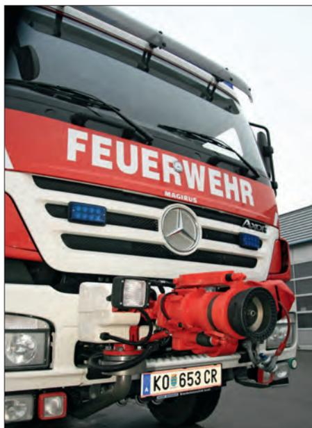
Der Front-Wasserwerfer kann vom Fahrersitz aus bedient werden
