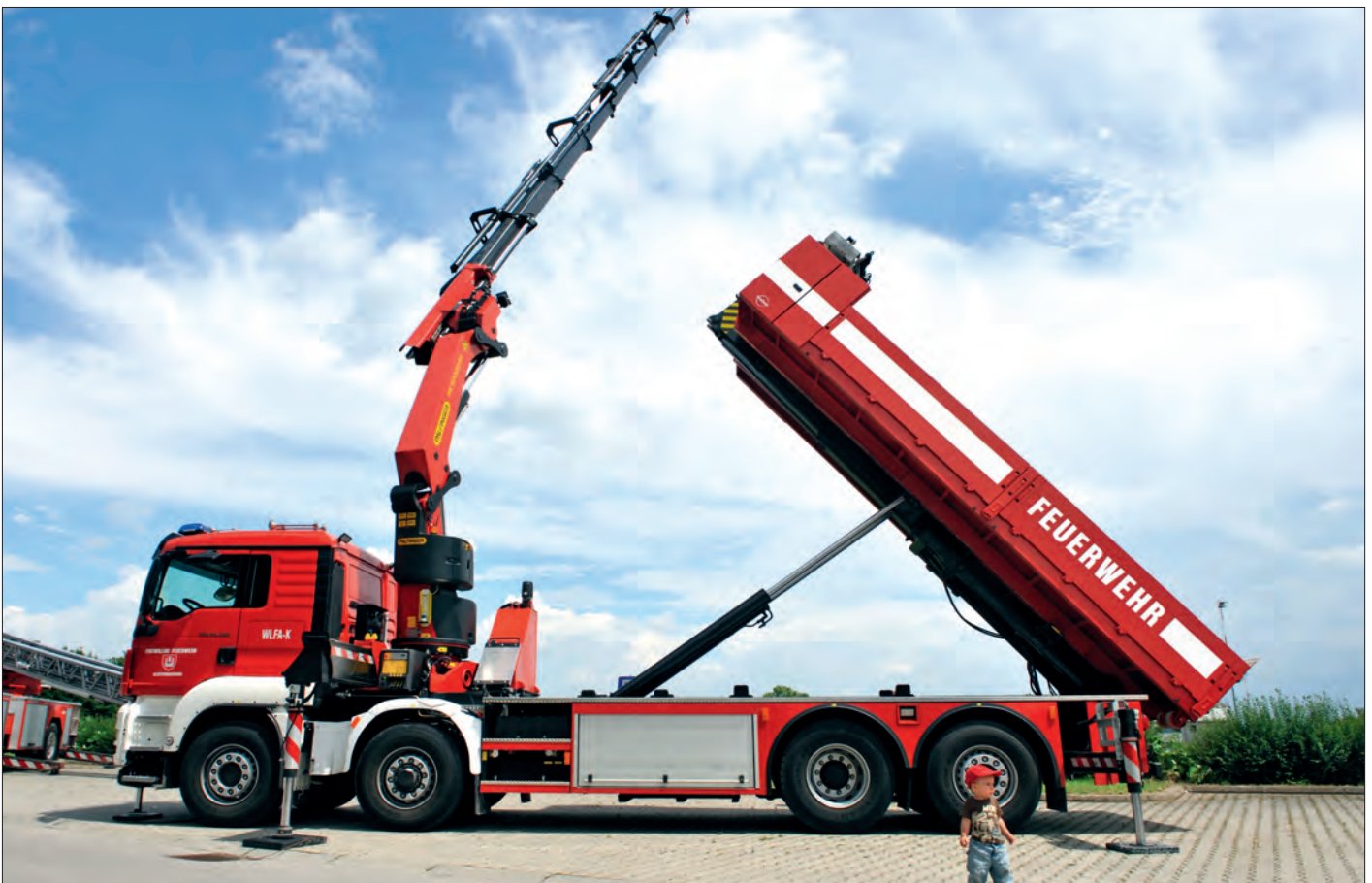
Kran: Bei einer Ausladung von 21 Metern kann eine Last von 1,5 Tonnen gehoben werden
