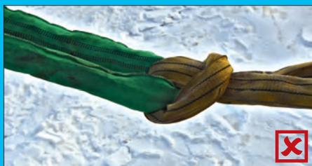
Auch falsch: Dieser Knoten wird sich nach Beanspruchung nicht mehr lösen lassen. Eine Rundschlinge lässt sich im gelockerten Zustand flexibel verknoten, ist sie jedoch ein Mal unter Zug gestanden, werden die feinen Kunststofffasern so dicht aneinander gepresst, dass Knoten nicht mehr zu öffnen sind.
