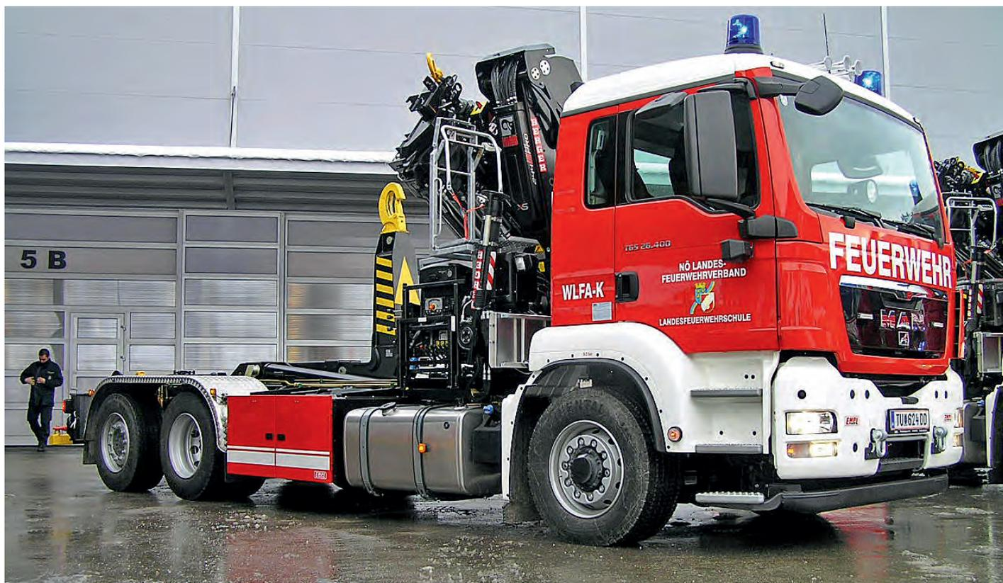
Die Wechselladefahrzeuge sind mit Abrollkipperanlage, Frontkran und einem Wechselladeaufbau ausgerüstet
