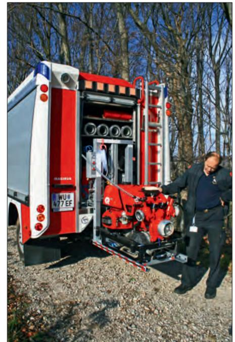
Auf einem Schlitten montiert kann die TS per Knopfdruck abgesenkt werden
