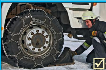
Bevor die Seilwinde in Betrieb genommen wird, sollte das Einsatzfahrzeug entsprechend abgesichert werden. Dazu können Seilwinden-Unterlagskeile verwendet werden.
