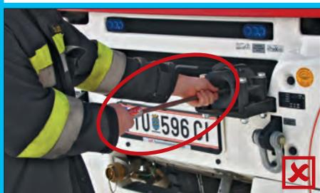
Beim Abspulen der Seilwinde unbedingt Schutzhandschuhe tragen. Sollte das Seil beschädigt sein, kann es leicht zu Handverletzungen kommen.
