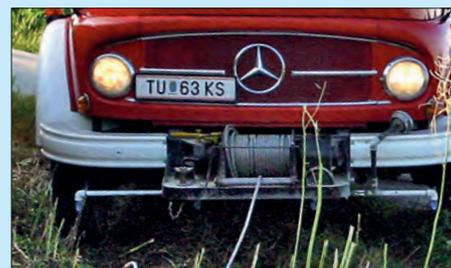
Beispiel einer Vorbau-Trommelwinde
