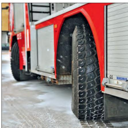
Die HA ist via Steuerhebel lenkbar
