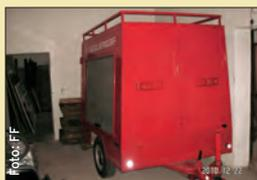
Feuerwehr Einachsanhänger komplett geschlossen vorne und hinten 2-flügelige Türen und seitlich Rolladern. Anhängerkupplung für Pkw 1010 kg und Traktor möglich. Eigengewicht 350 kg Gesamtgewicht 1010 kg Baujahr 1992
