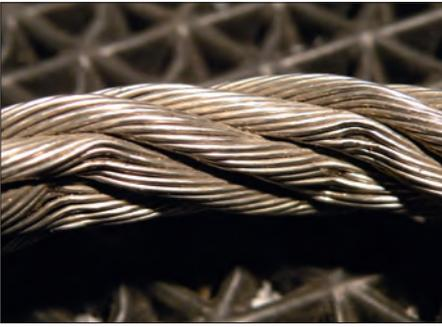
Ein geknicktes Drahtseil lässt auf unsachgemäße Verwendung schließen: für den Einsatz unbrauchbar
