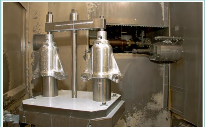
**Fräsen** Viele Bauteile des hydraulischen Rettungssatzes werden aus hochfesten Aluminiumlegierungen gefertigt. Dank der CNC-Maschinen geht das recht flott.
