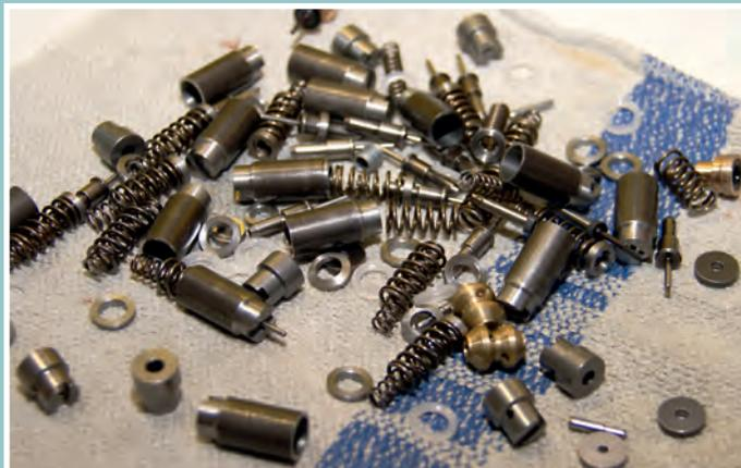
**Steuerventile** Zahlreiche Kleinteile, wie beispielsweise Federn, Hülsen und Scheiben sind später für eine optimale Steuerung des Gerätes verantwortlich.
