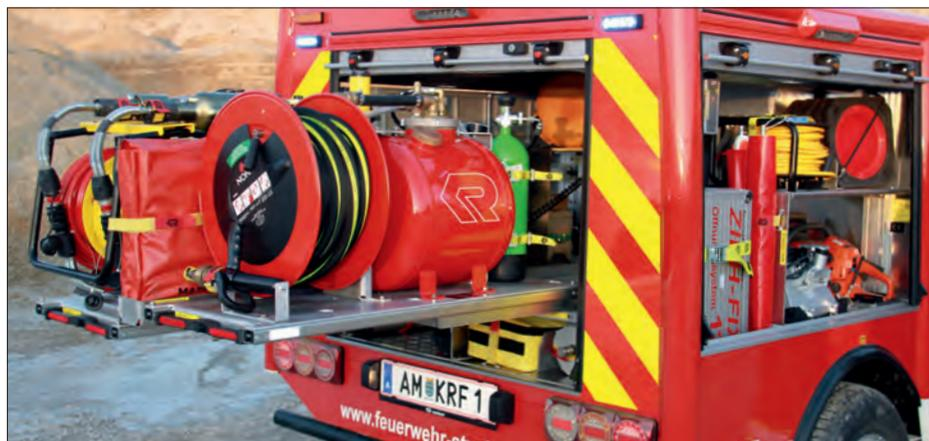
Ein hydraulisches Rettungsgerät und eine Löschanlage mussten u.a. Platz finden
