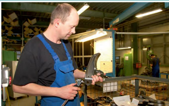
**Unzerstörbar** Die Scherenmesser und Spreitzer-spitzen sind aus hochfestem Werkzeugstahl gefertigt um gegen die härtesten Materialien zu bestehen.
