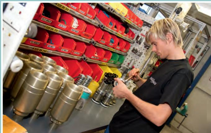
**Montage** Jetzt werden die einzelnen Bauteile zusammengesetzt. Auch hier ist wieder äußerste Präzision gefragt.
