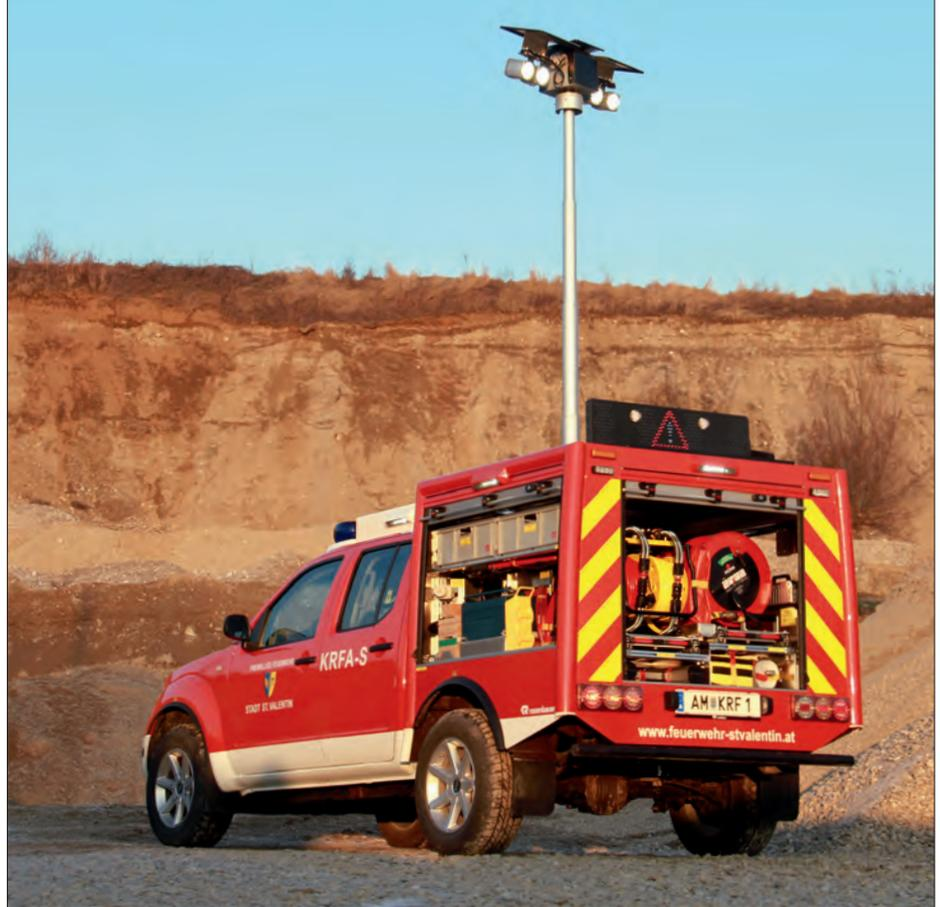
Highlight: Der pneumatisch ausfahrbare Xenon-Lichtmast
