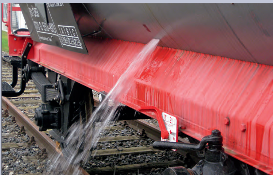
Wie man eine Leckage korrekt und rasch abdichtet, kann hier geübt werden
