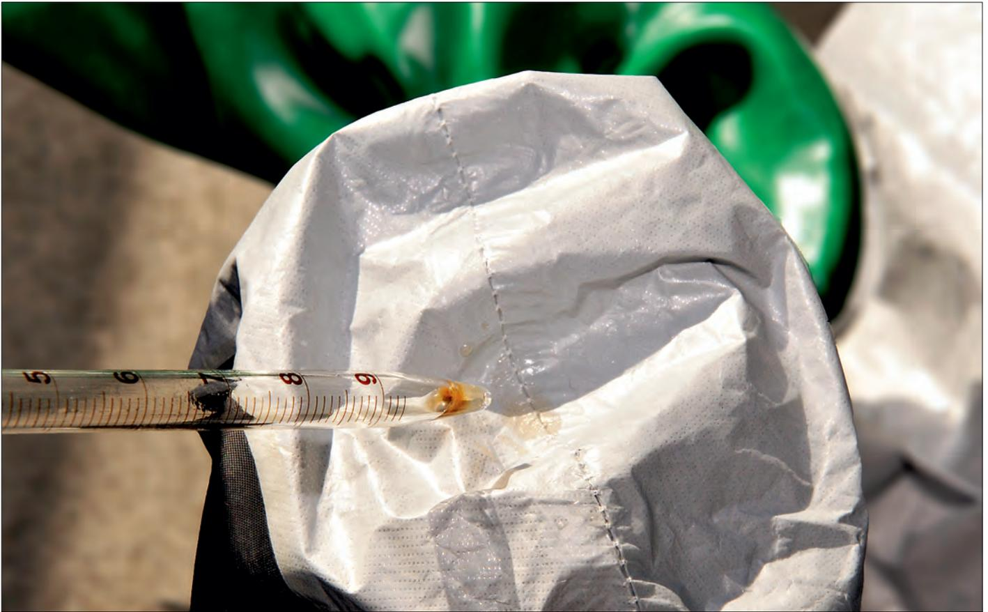
Auch die chemische Beständigkeit der Schutzanzüge wurde genau geprüft
