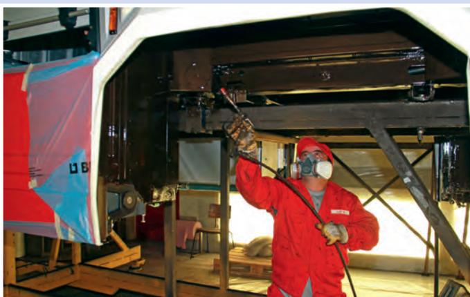
**10.** Nachdem der Aufbau fertig gestellt ist, wird der Unterbodenschutz aufgetragen. In weiterer Folge kann dann der Aufbau auf das Chassis aufgesetzt werden.
