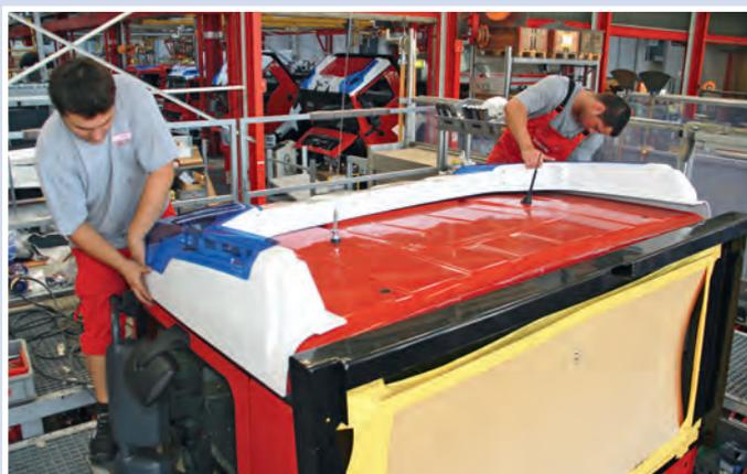
**9.** Die Vorbereitung des Fahrerhauses geht mit dem Aufsetzen des Dachüberbaus in die Endphase.
