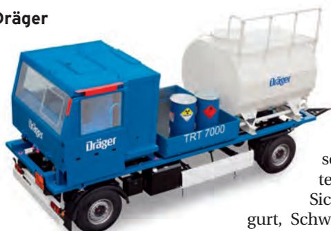
gefahren werden kann. Fahrzeugteile wie Frontscheibe, Seitenscheibe, Sicherheitsgurt, Schweller, Kabinenrückwand aus Blech, A-Säule oder Lkw-Tür-Halterung können bei der Übung zersägt oder zerschnitten und anschließend problemlos ersetzt werden. So kann die Feuerwehr die Übungsanlage beliebig oft einsetzen.
