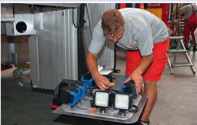
**4.** Bei der nächsten Fertigungslinie erfolgt die Montage der Rollläden, des Lichtmasts sowie der Galerie.
