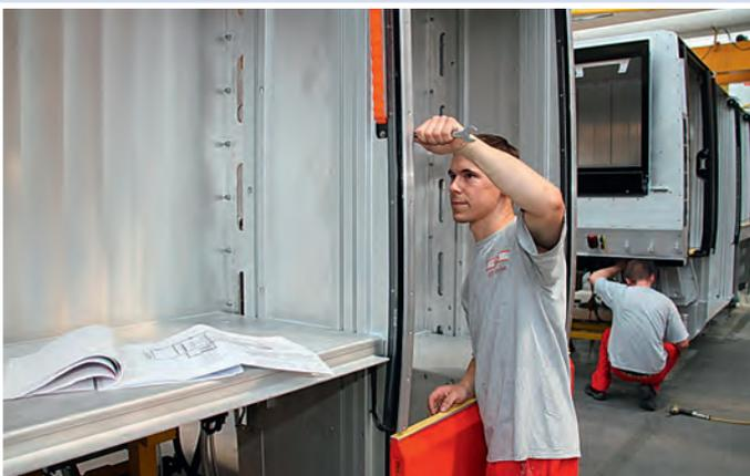
**2.** Die Mitarbeiter auf der Fertigungslinie setzen nun die einzelnen Bleche zusammen und verschrauben bzw. verkleben diese.
