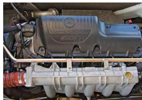
Der 5-Zylindermotor mit 2.688 ccm liefert 120 kW
