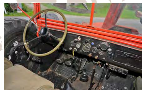
Das spartanische Cockpit: Meilentacho, Kühlwassertemperaturanzeige in Fahreinheit, Spannungsanzeige, ...
