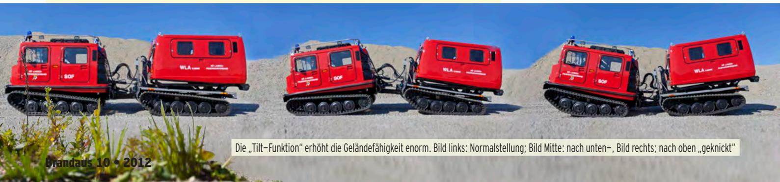
Die „Tilt-Funktion“ erhöht die Geländefähigkeit enorm. Bild links: Normalstellung; Bild Mitte: nach unten-, Bild rechts; nach oben „geknickt“
