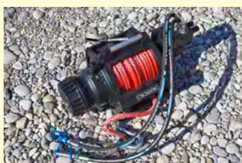
35 kN-Seilwinde mit Kunststoffseil
