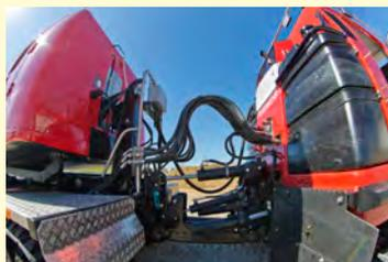
Knicklenkung mit zusätzlichem Tilt-Zylinder
