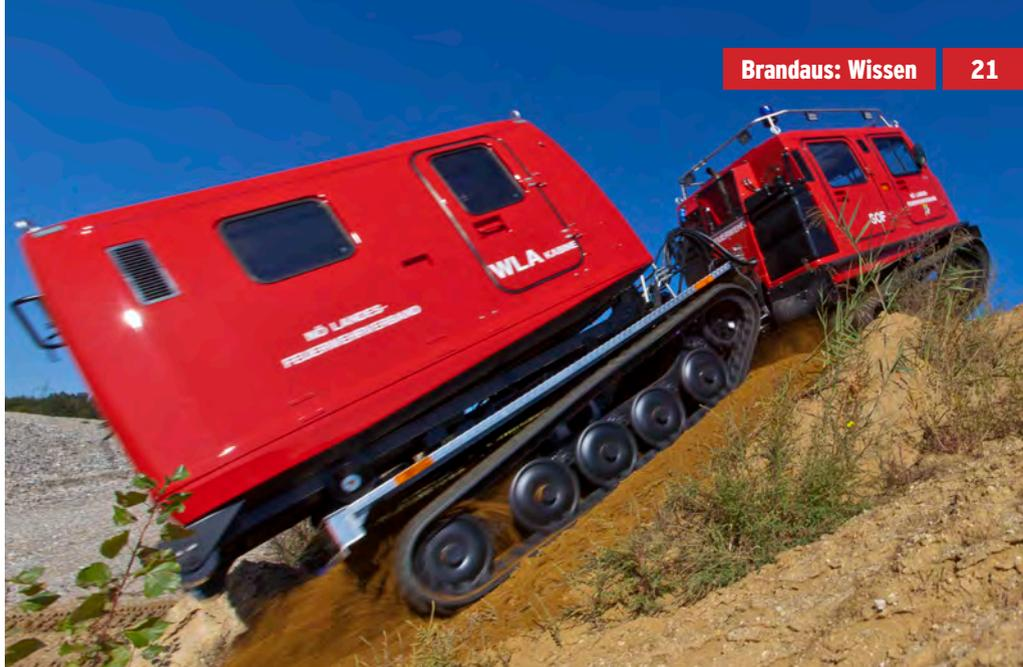
Auch losler, bis zu 45 Grad steiler Untergrund, stellt für das Gummikettenfahrzeug kein unüberwindbares Hindernis dar
