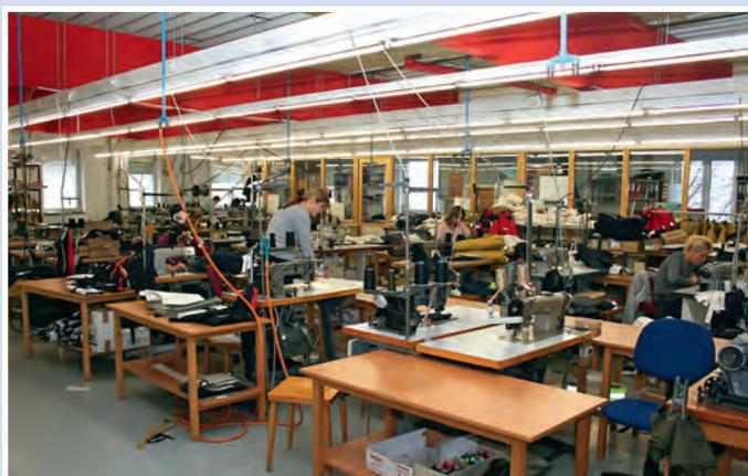
**5.** In der Näherei werden die einzelnen Bekleidungsstücke Schicht für Schicht zusammen genäht.
