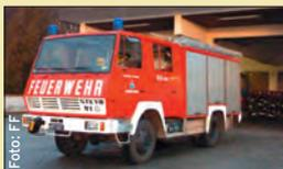
Fahrgestell: Steyr 791.210, 4x4, BJ 1987, Km-Stand: 20.300, Aufbau: Rosenbauer Gültige § 57a Überprüfung Wassertank 2000 Liter Seilwinde 5 t, Einbaupumpe (50 Stunden seit Generalüberholung), Hydraul. Rettungsatz (Fa. Weber), Stromaggregat 8 kVA (Fa. Bosch) HD-Haspel mit Schlauch Zum Verkaufen ab August 2012
