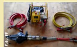
Weber-Hydraulikaggregat E330L-230V, 630 bar Betriebsdruck Baujahr: 08/1998 Weber-Kombigerät (Spreitzer und Schere) SPS 330, 630bar, Baujahr 1998 2 Garnituren Hydraulikschläuche
