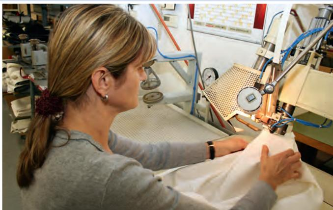
**6.** Die Naht der Membran (weiße Schicht in der Mitte des Lagenaufbaus), die vor allem für Wasserdichtheit sorgt, muss zusätzlich verschweißt werden,...
