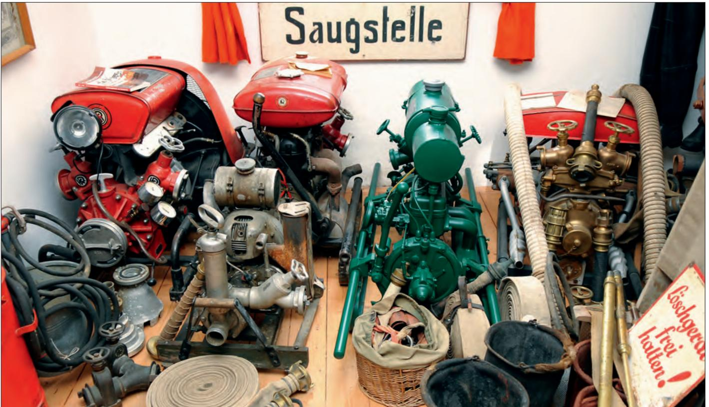
Löschgeräte aus vergangenen Tagen: Tragkraftspritze, Kübel, Schläuche und Verteiler
