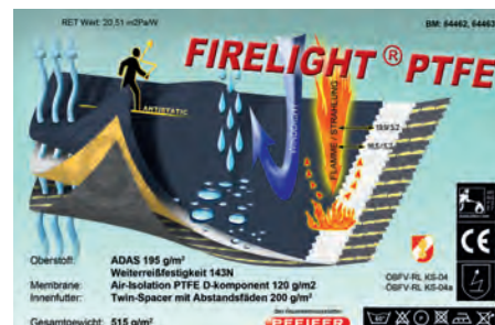
Lagenaufbau der Stufe 2
