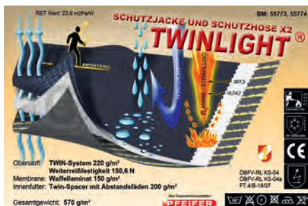
Lagenaufbau der Stufe 2
