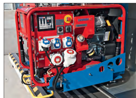
Der Stromerzeuger (mind. 5 kVA) ist im Geräteraum zwei untergebracht
