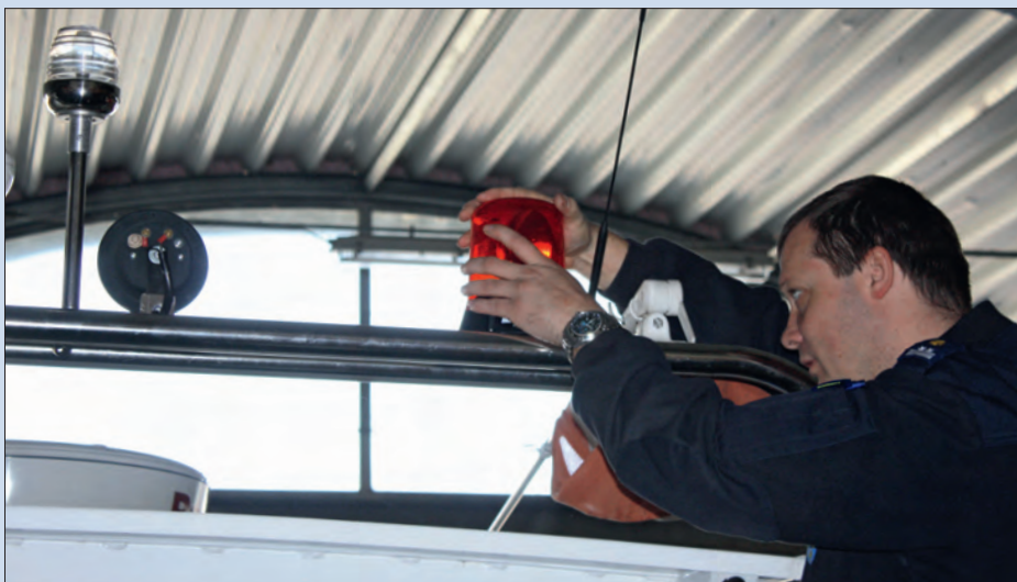
Die Arbeitsgruppe Boote empfiehlt, dass das rote Funkellicht bei den Arbeitsbooten nachgerüstet wird
