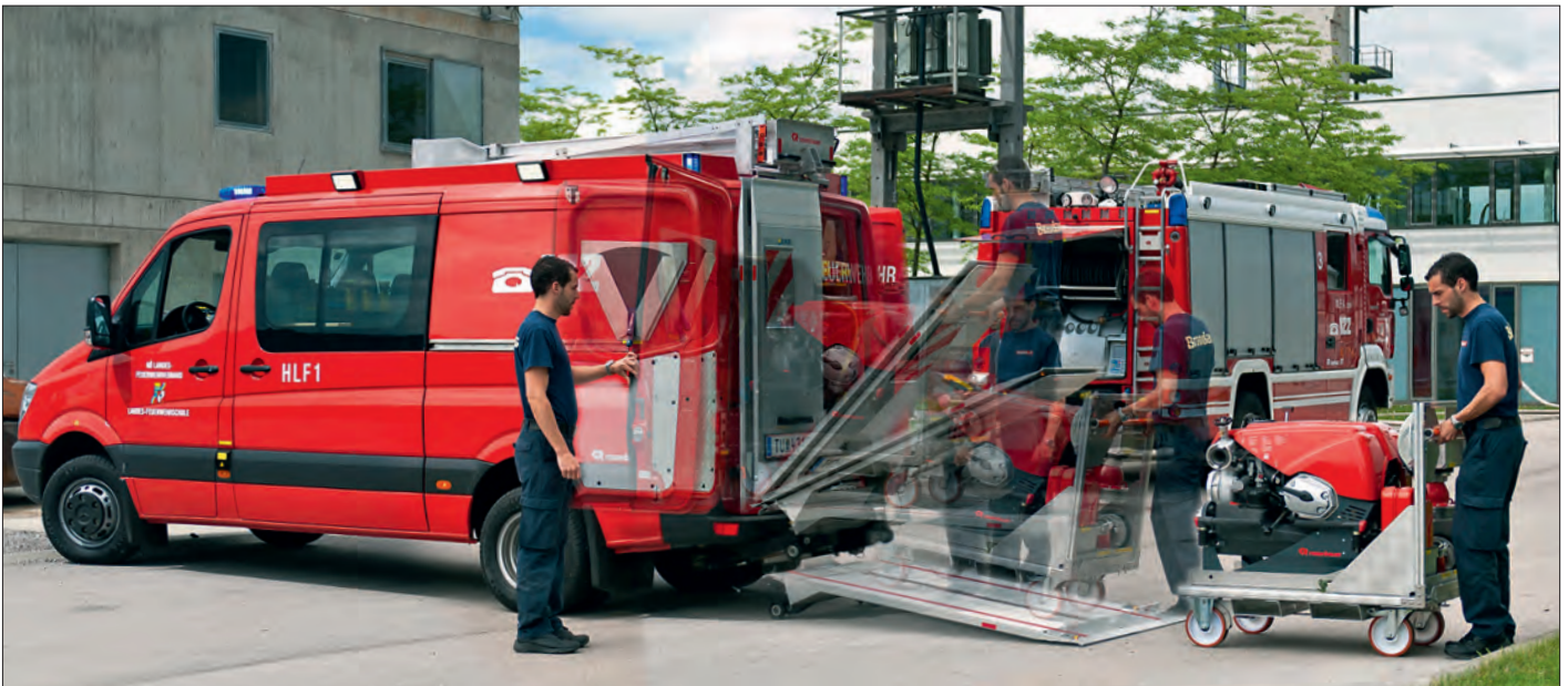
Die hydraulisch betriebene Hubladebühne ermöglicht ein sehr einfaches und rasches Be- und Entladen des Rollcontainers mit Tragkraftspritze
