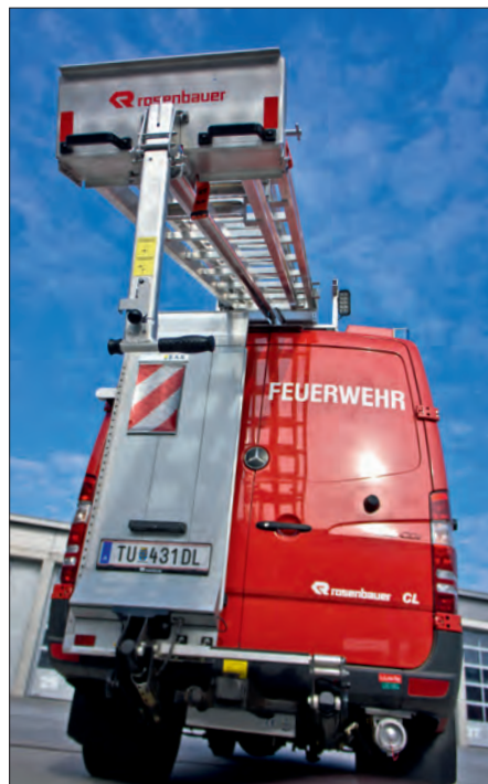
Die Entnahme der Feuerwehrleiter kann vom Boden aus gemacht werden
