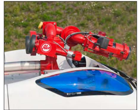
Der Wasserwerfer wird vom Cockpit aus via Joystick gesteuert. Mit max. 2.400 l/min erreicht er eine Wurfweite von 54 Meter
