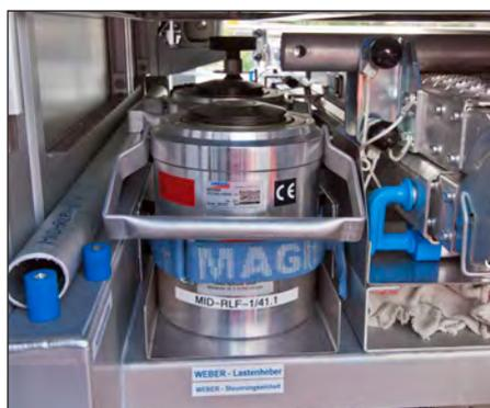
60 Tonnen Hublast bringt einer der beiden Schwerlastheber, die über das Aggregat des hydr. Rettungssatzes betrieben werden
