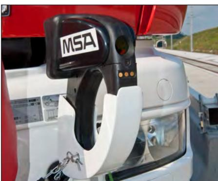
Die an der Stoßstange montierte Wärmebildkamera überträgt die Livebilder in die Kabine des Feuerwehrfahrzeuges
