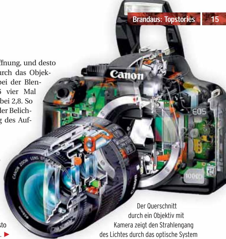
Der Querschnitt durch ein Objektiv mit Kamera zeigt den Strahlengang des Lichtes durch das optische System
