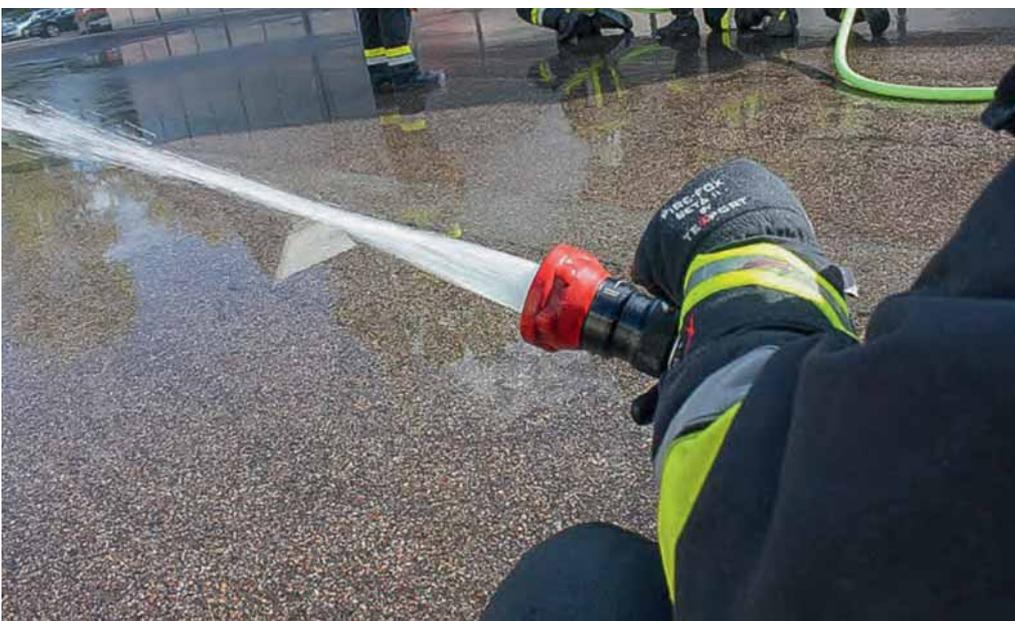
Für den sanften Vollstrahl muss das Strahlrohr nicht vollständig geöffnet werden.
