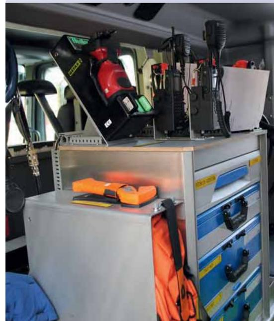
Bild oben: Der zwischen den Sitzen angeordnete „Action-Tower“ auf dem verschiedene Gerätschaften untergebracht sind
