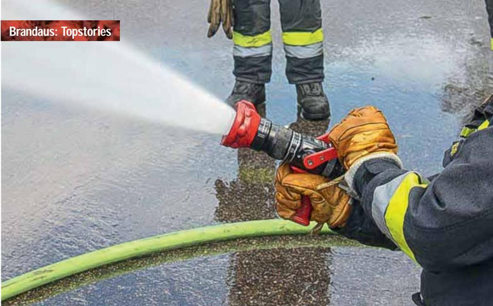
Um für die Rauchgaskühlung die optimale Tropfengröße zu erreichen, muss das Strahlrohr ganz geöffnet werden.
