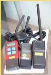
(4m Band) inkl. Akku und Ladestation, teilweise mit Lautsprechermikrofon. Unterschiedliche Hersteller (NIROS, Motorola, etc)!
