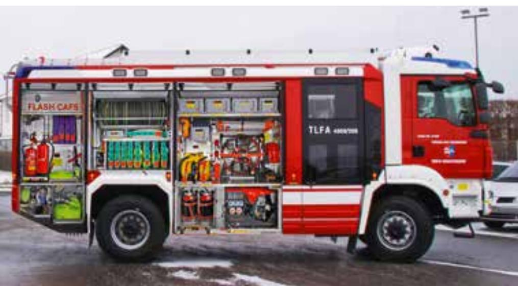
Die „FLASH CAFS“-Anlage befindet sich im hinteren Drittel des Feuerwehrfahrzeuges
