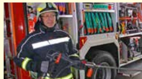
Löschlanze für Strahlrohr NEPIRO
