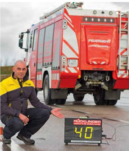
Beim Versuch einen 18-Tonner, der mit 50 km/h unterwegs ist, zum Stillstand zu bringen, wurde ein Bremsweg von ca. 22 Metern ermittelt (ohne Reaktionsweg!). Bei gleicher Annahme, jedoch mit 60 km/h, würde dieses Tanklöschfahrzeug nach 22 Metern Bremsweg mit einer Restgeschwindigkeit von ca. 40 km/h auf das Hindernis auftreffen
