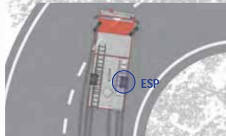
Falls es zum Schieben bzw. Untersteuern kommt, greifen ESP und ABS auf das hintere rechte Rad, um das Fahrzeug wieder unter Kontrolle zu bringen
