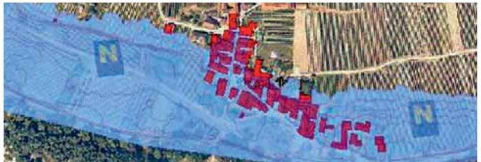
Bild 7: HSBPS – Hier erkennt man sehr gut, die veränderte Wasseranschlagslinie im Ortsgebiet von Oberloiben und die vermehrte Anzahl an orange eingefärbten Gebäuden bei Pegelstand 11.000m<sup>3</sup>/s in Kienstock. Die Justierung der Durchflussmenge kann an der Donau in Schritten von 500 m<sup>3</sup>/s erfolgen, wodurch sehr exakte Räumungsempfehlungen für den Einsatzleiter vor Ort erstellt werden können.
