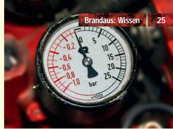
Das am Saugengang der Pumpe angebrachte Vakuum-Manometer zeigt den Unter- bzw. Überdruck am Saugengang an
