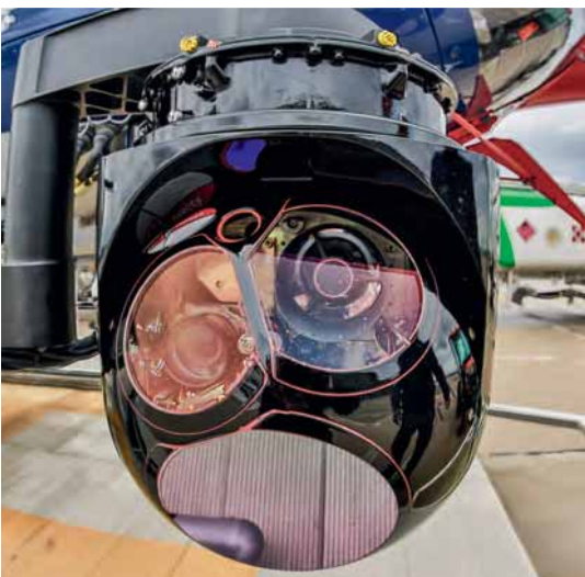
Der Dom mit den drei unterschiedlichen Kamerasystemen – via Downlink in Echtzeit zur Bodenstation übertragbar – auch zu mobilen Bodeneinheiten
