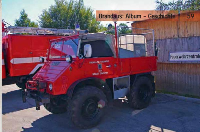
Mercedes Unimog 30: Baujahr 1960, 22 kW Motorleistung und 3200 kg Gesamtmasse
