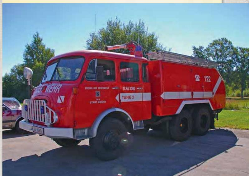
Steyr 680M: die höchstzulässige Gesamtmasse beträgt 12 t. Das Fünfgang-Getriebe ist nicht synchronisiert, es muss daher mit Zwischengas und Doppelkuppeln geschaltet werden
