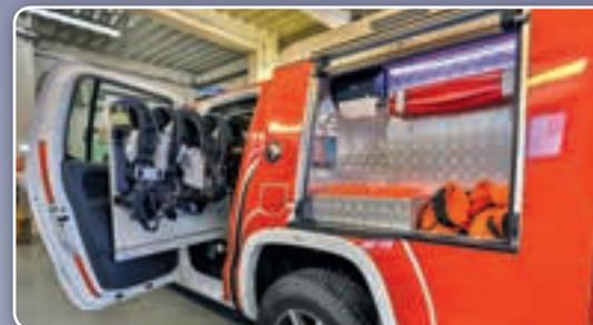
Technische Geräte, wie beispielsweise Motorkettensäge, Glas- und Bolzenschneider, aber auch ein Feuerlöscher sind auf der rechten Fahrzeugseite zu finden.
