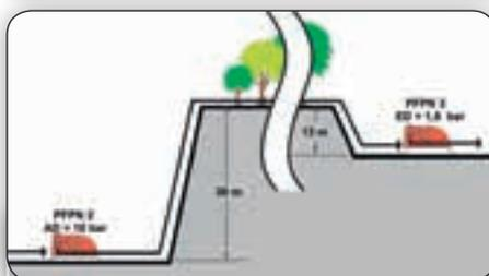
Beispiel 2: Bei einer Löschwasserversorgung ist das Geländeprofil entsprechend zu beachten.
