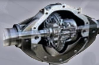
Diese besteht aus einem normalen Differential und einer mechanischen Sperre, die bei Geländefahrten manuell zugeschaltet wird und das Differential außer Funktion setzt und blockiert, sodass die vom Differential bekannte Ausgleichsfunktion nicht mehr gegeben ist.
