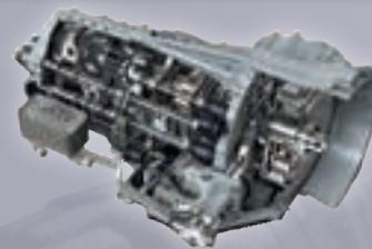
Damit wird das Getriebe des Fahrzeuges untersetzt (Änderung/Verringerung des Übersetzungsverhältnisses). Die Geländeuntersetzung erhöht die Kraft bei gleichzeitig reduzierter Geschwindigkeit. Zumeist muss das Fahrzeug angehalten werden, um die Untersetzung zu aktivieren.
