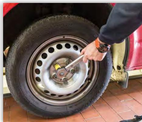
Eine Kontrolle der Radschrauben kann nicht schaden! Das Anzugsdrehmoment sollte in der Vertragswerkstätte erfragt werden, da dieses je nach Fahrzeug und Felge variiert. In der Regel liegt es zwischen 120 Nm bei Personenkraftwagen und 600 Newtonmeter bei Lastkraftwagen. Wenn die Räder nicht in der Vertragswerkstätte gewechselt werden, sollten nach 50 Kilometern die Radschrauben nochmals auf Festigkeit kontrolliert und im Bedarfsfall nachgezogen werden.
