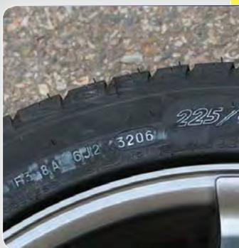
davon aus, dass ein sachgemäß gelagerter Reifen bis maximal drei Jahre nach Produktionsdatum den Qualitätsansprüchen eines Neureifens gleichen Modells entspricht.
