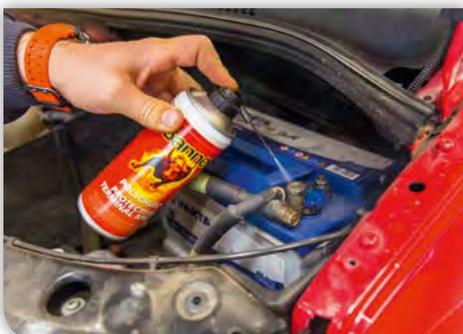
Um Korrosion zu verhindern, müssen die Pole regelmäßig mit Spezialmitteln eingesprüht werden. Im Fachhandel gibt es eine riesige Auswahl an Sprays und Fetten.
