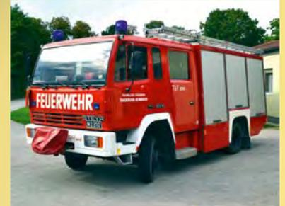
**Steyr 10S18,** Baujahr: 1989, Kilometerstand: 8.000, Aufbau **Rosenbauer Lichtmast 4 x 1000W, Stromerzeuger Bosch 8kVA, Wasserwerfer, Elektroseilwinde Maxwald 5 to,** Grundüberholung Rosenbauer 2010
