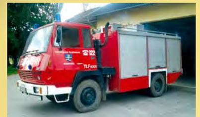
**Steyr 1291,** Baujahr 1980, Leistung: 206 kW (280 PS), Aufbau: **MUT,** Baujahr 1990, **Magirus Einbaupumpe mit 137 Betriebsstunden, Lichtmast 2 x 1500 Watt, §57a-Plakette bis 10/2015**
