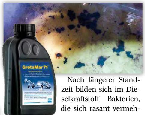
Nach längerer Standzeit bilden sich im Dieseldieselkraftstoff Bakterien, die sich rasant vermehren und den Dieselfilter und diverse Kraftstoffleitungen verstopfen. Vorgeugend gibt es im Fachhandel Zusätze (z.B. Grotamar 71), die diese Bakterien abtöten. Betroffene Fahrzeuge können mit „Schockdosierung“ behandelt werden. ■
