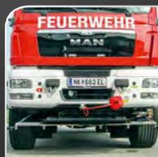
Im Bereich der vorderen Stoßstange sind eine 50 kN Seilwinde von Rotzler sowie eine Straßenwaschanlage zu finden.
