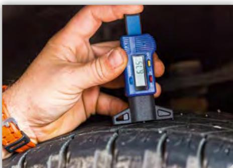
Bei Pkw-Winterreifen muss diese mindestens vier Millimeter und bei Lkw-Pneus mindestens sechs Millimeter betragen (nur bei Radialreifen; Diagonalreifen sind kaum mehr erhältlich). Außerdem sollten die Reifen nicht länger als zehn Jahre verwendet werden, da die Gummimischung aushärtet und damit die Haftung auf der Straße, speziell bei nasser und eisiger Straße, verringert wird. Das Herstellungsdatum der Reifen ist auf der Flanke zu finden und gibt Auskunft über das Alter der Gummis.
