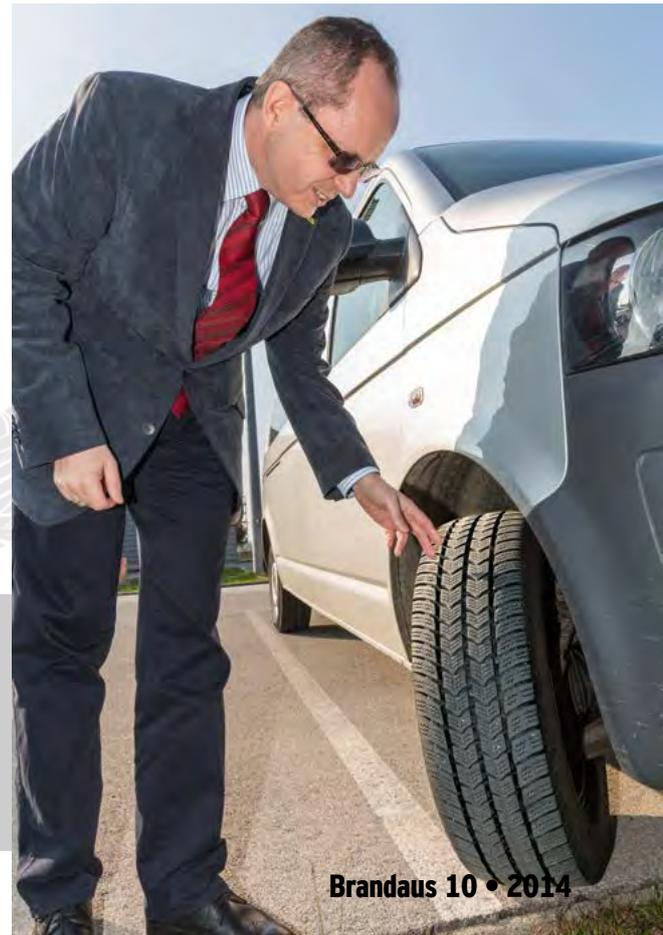
**Bilderserie rechts:** Die Kräfte, die auf die schwarzen Pneus einwirken, sollte man nicht unterschätzen. Darum sind Reifendruck, richtige Gummimischung (Winter/Sommer), Profiltiefe und Reifenalter für optimale Bodenhaftung von großer Bedeutung.
