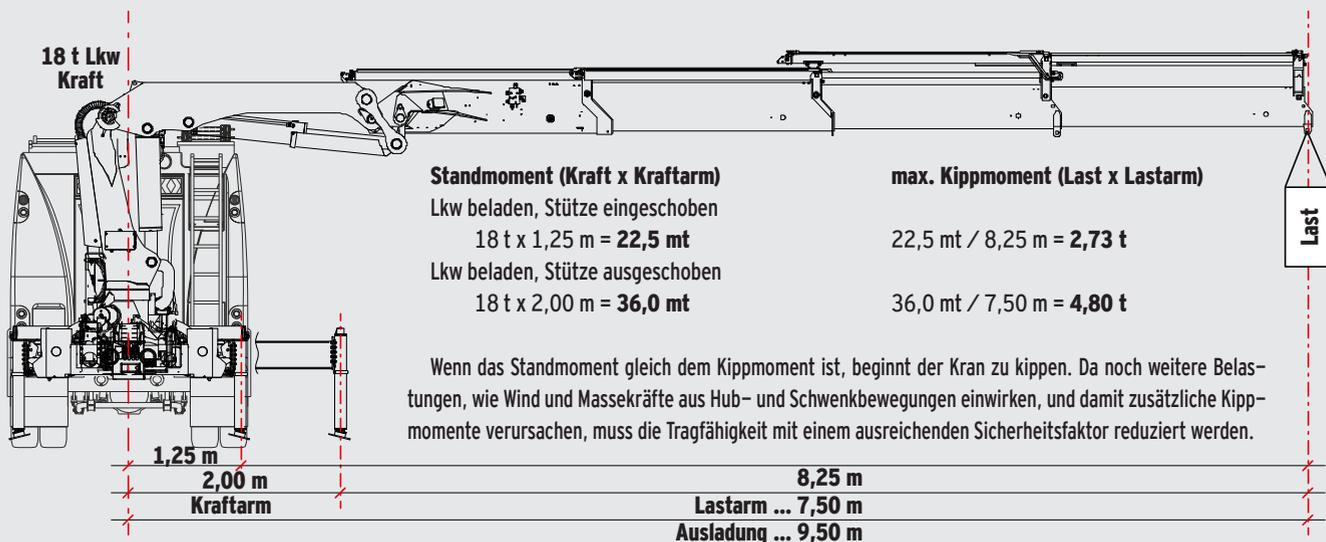
Wenn das Standmoment gleich dem Kippmoment ist, beginnt der Kran zu kippen. Da noch weitere Belastungen, wie Wind und Massekräfte aus Hub- und Schwenkbewegungen einwirken, und damit zusätzliche Kippmomente verursachen, muss die Tragfähigkeit mit einem ausreichenden Sicherheitsfaktor reduziert werden.
