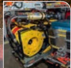
**Weber RSX 200107 Plus Schere:** Die Öffnungsweite beträgt 200 mm, die maximale Schneidleistung bei Rundmaterial ist mit 43 mm begrenzt.
