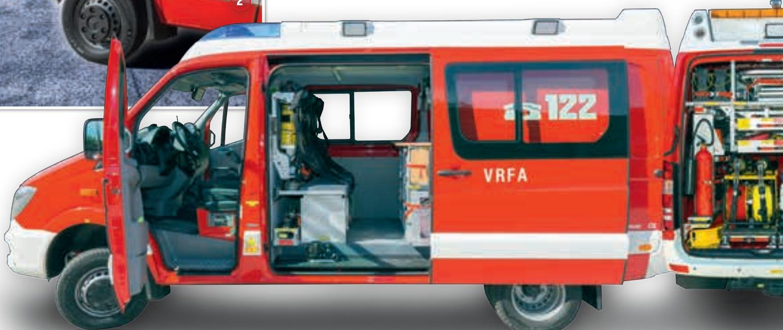
hydraulischen Rettungssatz liegen Trennschneider und Schlagbohrmaschine sowie Wagenheber griffbereit auf einem Auszug.
