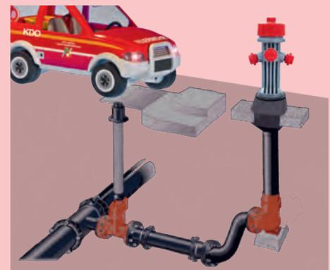
Schematische Darstellung eines Oberflurhydranten
