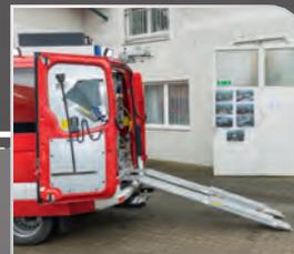
Die stabilen Aluminiumrampen fungieren als Entladungshilfe für die rund 180 Kilogramm schwere Tragkraftspritze.
