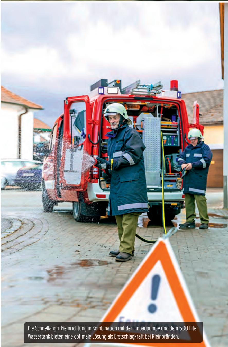
Die Schnellangriffseinrichtung in Kombination mit der Einbaupumpe und dem 500 Liter Wassertank bieten eine optimale Lösung als Erstschlagkraft bei Kleinbränden.
