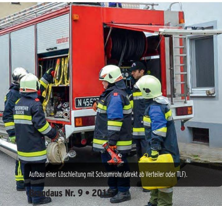
Aufbau einer Löschleitung mit Schaumrohr (direkt ab Verteiler oder TLF).
