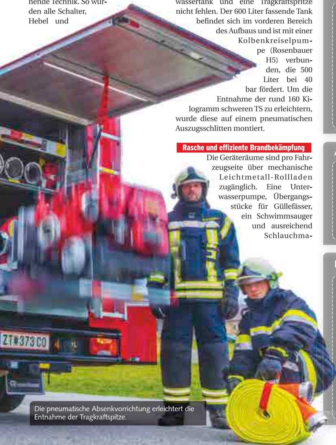
Die pneumatische Absenkvorrichtung erleichtert die Entnahme der Tragkraftspritze.
