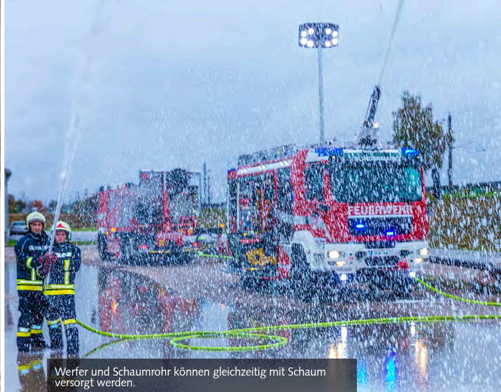
Werfer und Schaumrohr können gleichzeitig mit Schaum versorgt werden.
