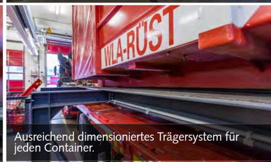
Ausreichend dimensioniertes Trägersystem für jeden Container.
