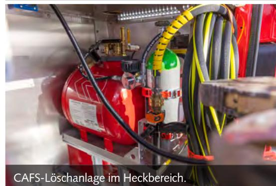
CAFS-Löschanlage im Heckbereich.
