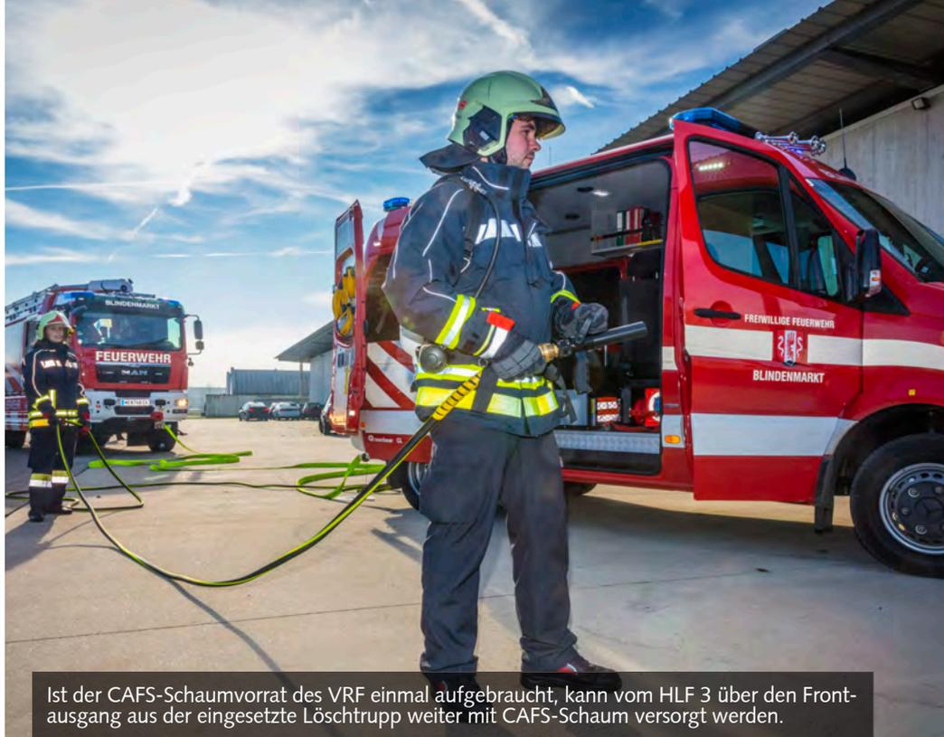
Ist der CAFS-Schaumvorrat des VRF einmal aufgebraucht, kann vom HLF 3 über den Frontausgang aus der eingesetzte Löschrupp weiter mit CAFS-Schaum versorgt werden.
