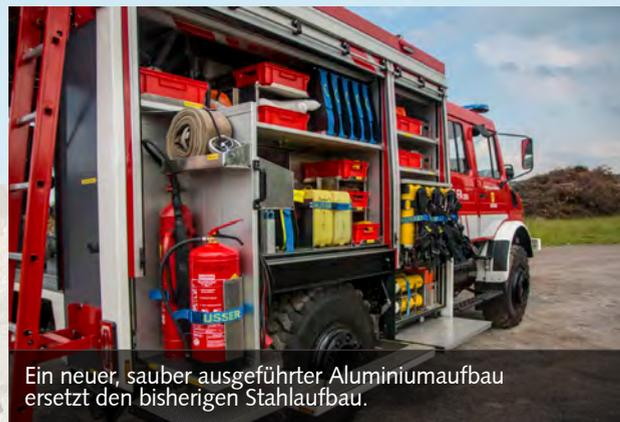
Ein neuer, sauber ausgeführter Aluminiumaufbau ersetzt den bisherigen Stahlaufbau.
