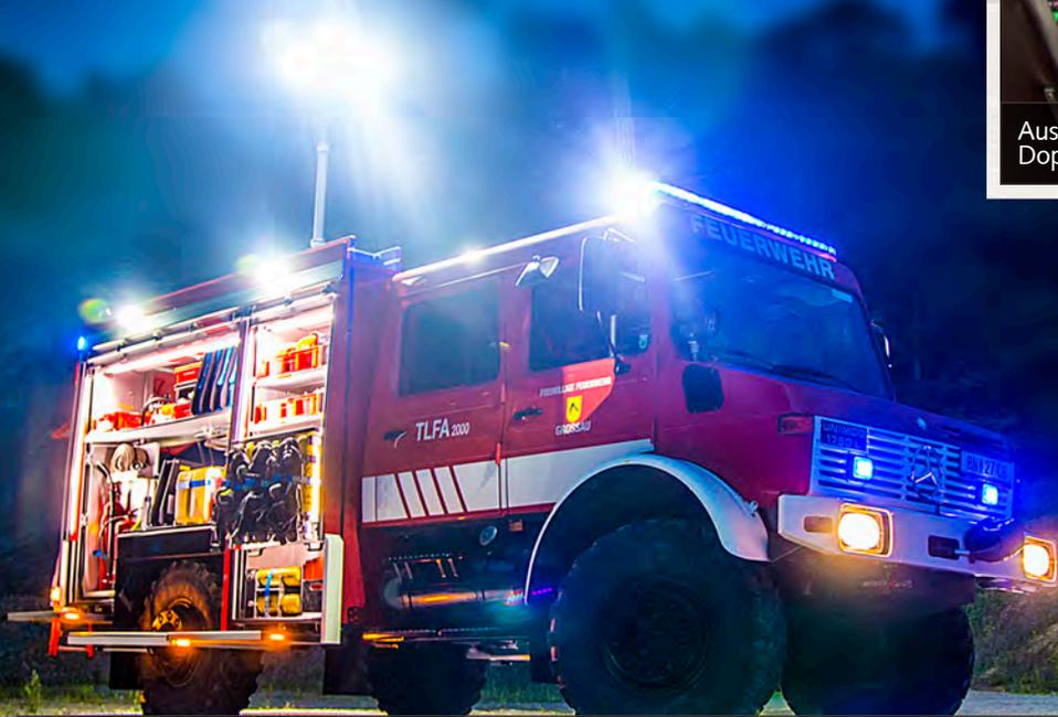
Im Zuge des Refurbishing des „alten“ Fahrzeuges wurde auch die Umfeldbeleuchtung sowie der Flutlichtmast auf LED-Leuchtmittel umgestellt.
