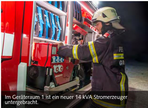
Im Geräteraum 1 ist ein neuer 14 kVA Stromerzeuger untergebracht.
