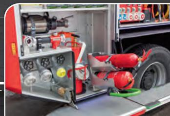
Im Beladerraum sechs sind neben der Schaumrüstung und den Druckabgängen der Einbaupumpe auch die mobilen Feuerlöschgeräte griffbereit auf einem Kippfach untergebracht.
