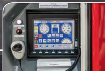
Das Bedienkonzept der Einbaupumpe wurde grafisch ansprechend aber vor allem logisch und einfach umgesetzt. Zusätzlich zur Pumpe können die Umfeldbeleuchtung, die Verkehrsleiteinrichtung und die Einsatzsignale gesteuert werden.
