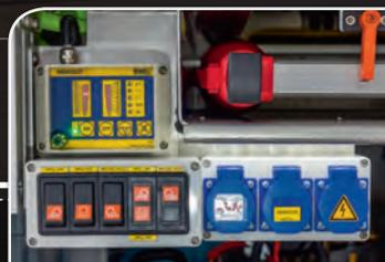
Klar und übersichtlich ist die Steuerung des Einbaugenerators im Heckladerraum untergebracht. Zusätzlich zur Steuerung der Umfeldbeleuchtung sind auch drei 230 Volt Steckdosen an dieser Stelle verbaut.
