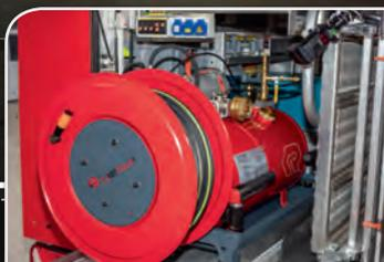
Durch Aufdrehen des Druckluftflaschenventils und Betätigen des CAFS-Strahlrohres ist die Löschanlage einfach und schnell in Betrieb zu nehmen.
