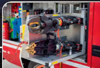
Der akkubetriebene Rettungssatz hält auf einem drehbaren Fach auf der rechten Fahrzeugseite im Laderraum 2. Auf der Rückseite befinden sich Rettungszylinder, Schwelleraufsätze und Rettungszylinderverlängerungen.
