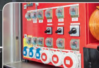
Der Einbaustromgenerator hat eine max. Leistung von 30 kVA und ist ausreichend dimensioniert, um alle elektrisch betriebenen Geräte die im Fahrzeug mitgeführt werden, mit Strom zu versorgen.
