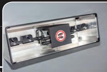
Der pneumatische Lichtmast, ausgestattet mit vier 40 Watt LED-Scheinwerfern, wird über die Bordspannung betrieben. Mit der Kabelfernbedienung kann dieser auf max. zwei Meter über Fahrzeugoberkante ausgefahren, gedreht und geschwenkt werden.
