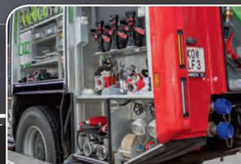
Zusätzlich zu zwei Tauchpumpen, Verteiler und Überdruckbegrenzungsventil sind auch drei C-Hohlstrahlrohre im Beladerraum 5 untergebracht. Auch ein B-Füllschlauch lagert griffbereit.
