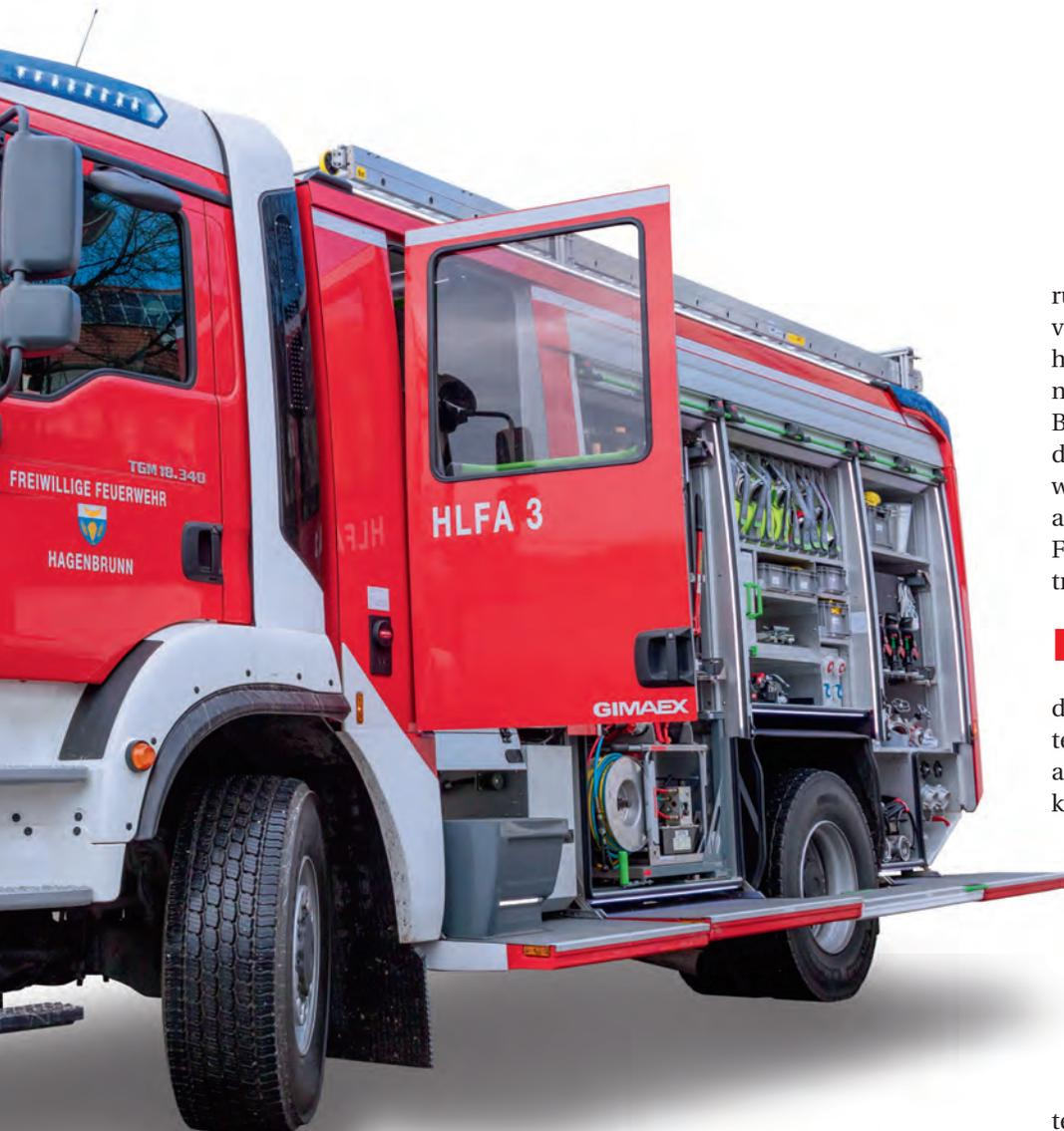
rung können alle Funktionen entweder vom Pumpenbedienstand oder Führerhaus durchgeführt werden. Der Maschinist wird permanent über alle wichtigen Betriebszustände, die übersichtlich auf dem 10,4 Zoll LCD-Bildschirm angezeigt werden, informiert. Zusätzlich können alle einsatzrelevanten Funktionen des Fahrzeuges wie Treibstoffstand oder Betriebsspannung abgerufen werden.“
