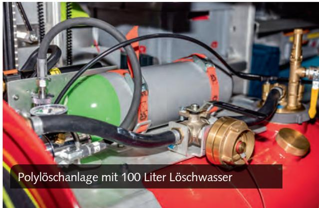
Polylöschanlage mit 100 Liter Löschwasser
