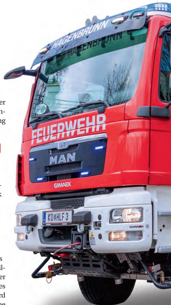
halb der vorderen Stoßstange wurde die Straßenwaschanlage mit drei integrierten Bodensprühdüsen verbaut, welche elektropneumatisch über das Bediendisplay einzeln steuer- und lenkbar sind. Mit diesem Hilfsmittel kann eine Gruppe autark kleine Schadensereignisse im Unwetterfall abarbeiten. ▶
